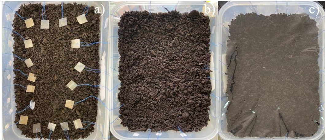
Slika 21. Tijek pripreme za proces biorazgradnje: a) uzorci poredani na 300g tla u posudi, b) uzorci prekriveni s još 300g tla, c) posuda prekrivena folijom
