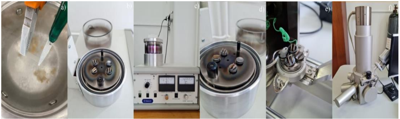
Slika 19. Tijek pripreme uzorka za SEM analizu: a) smrzavanje uzorka u tekućem dušiku, b) postavljanje uzorka na nosače za napanje, c) napanje uzorka legurom zlata i paladija, d) uzorci nakon napanja, e) uzorci neposredno prije analize na SEM-u, f) pretražni elektronski mikroskop, SEM
