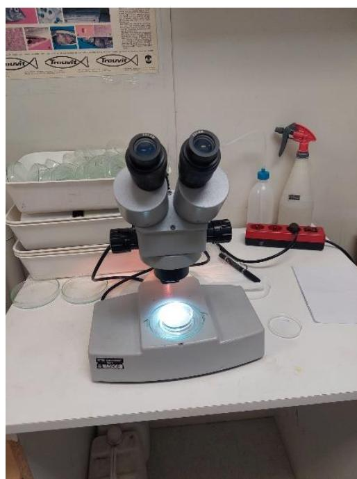
**Slika 20.** Stereo lupa za promatranje uzorka pod povećanjem 10-40 puta
