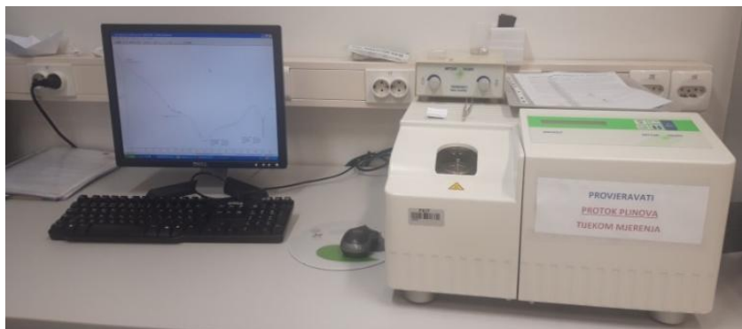
Slika 9. Diferencijalni pretražni kalorimetar, Mettler Toledo DSC 823e .
