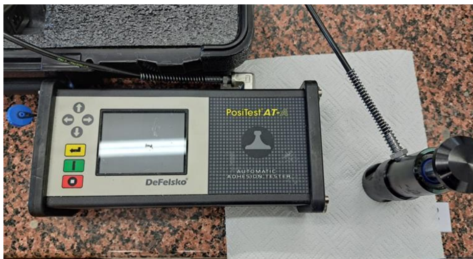
Slika 15. PosiTest AT-A, uređaj za izvođenje pull-off testa
