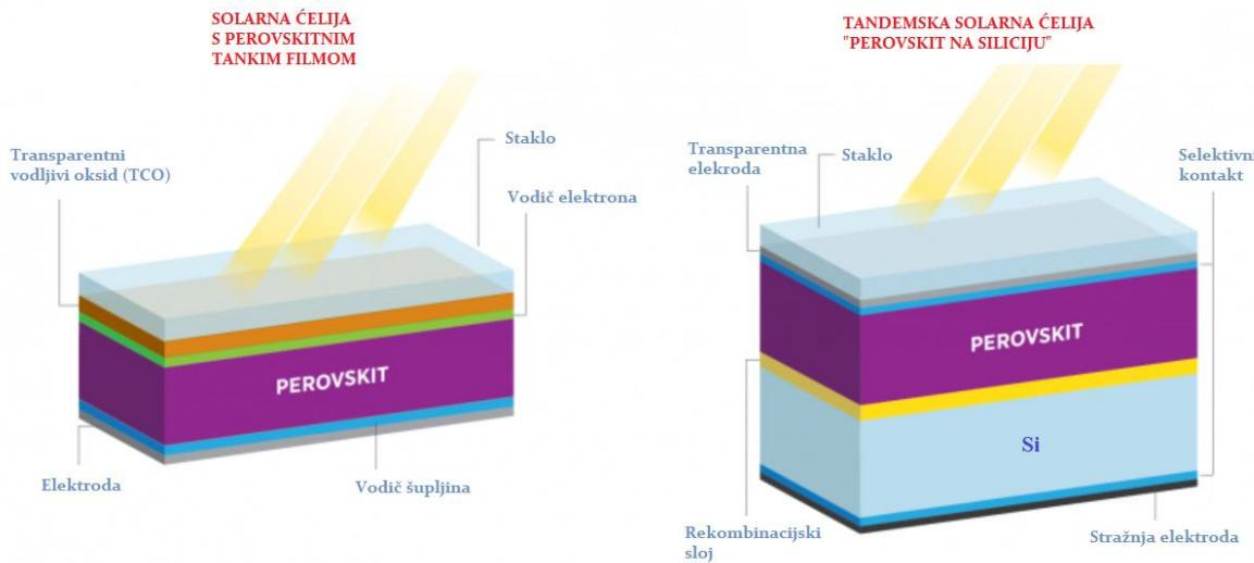
*Slika 4.* Presjek perovskitne solarne čelije i tandemske solarne čelije [18]
