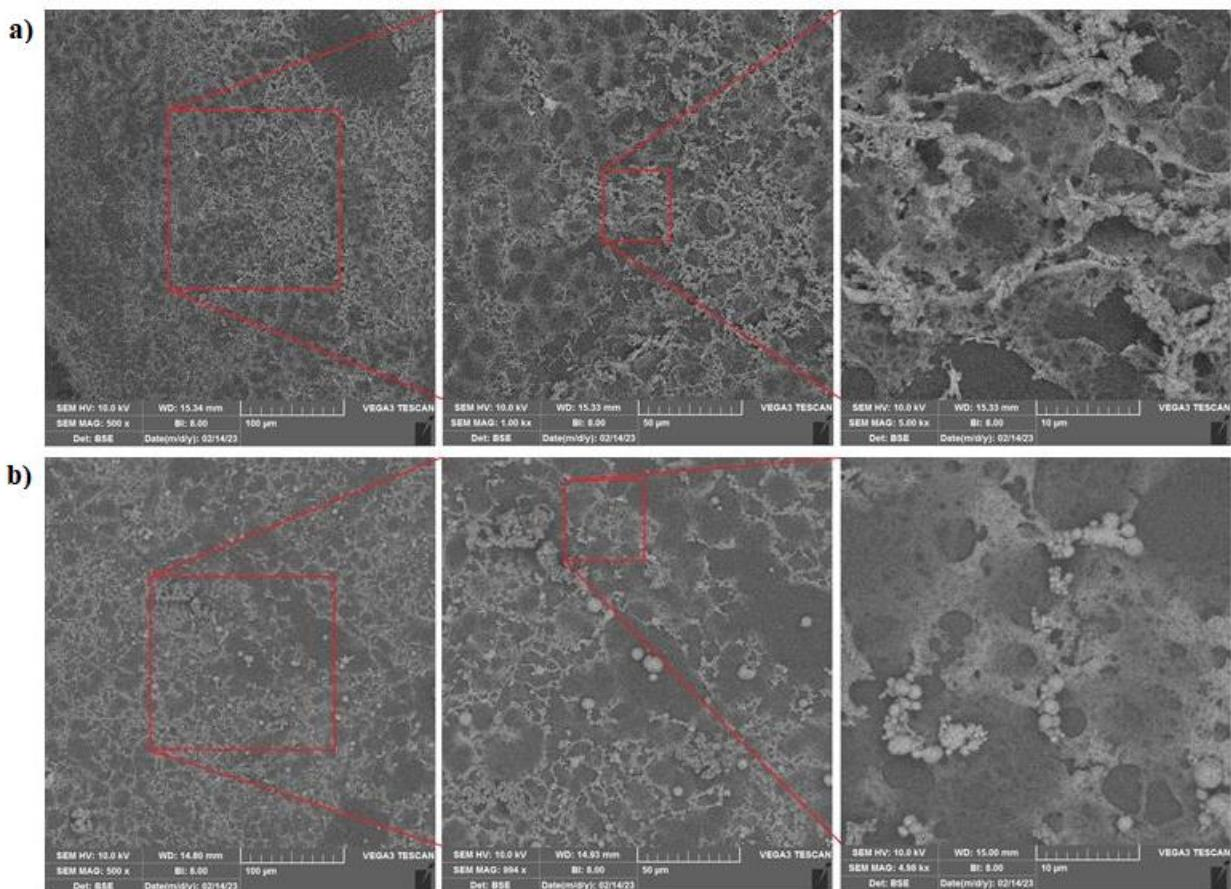
Slika 12. SEM mikrografije LaMnO<sub>3</sub> tankih filmova: a) IPL\_lim2\_3 i b) IPL\_lim2\_5b snimljene pri povećanjima od 500x, 1000x i 5000x
