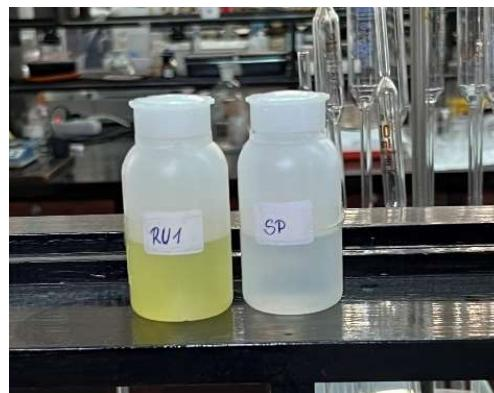
**Slika 24.** Pripremljene otopine za ICP-OES analizu
