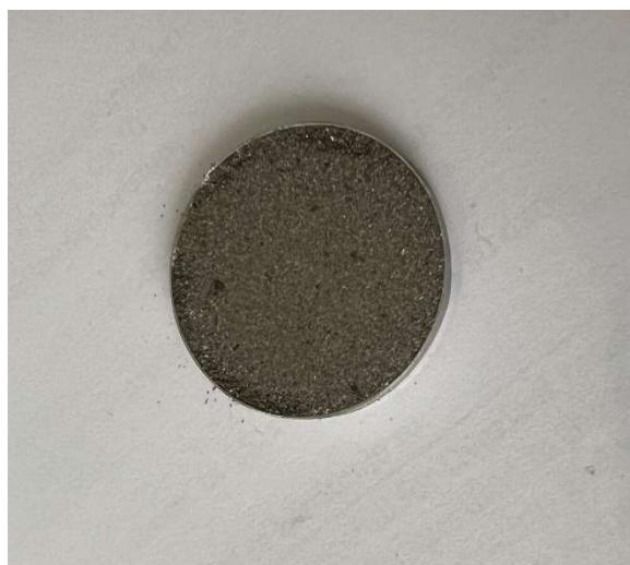
**Slika 26.** Pripremljeni uzorak za EDXRF analizu
