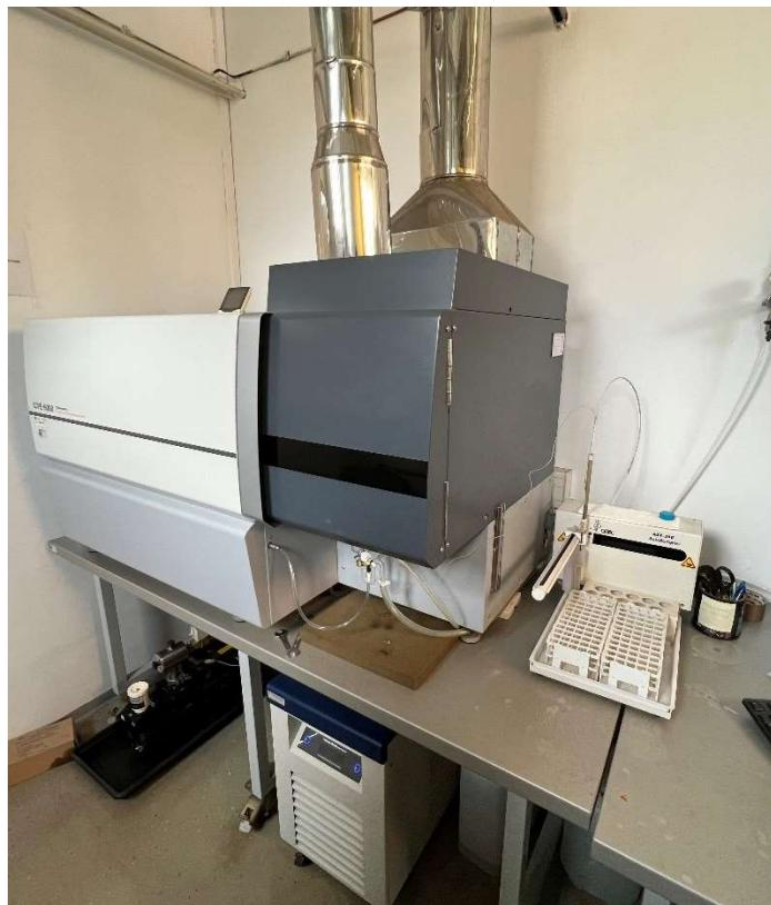
**Slika 13.** ICPE-9000 (lijevo) i AutoSampler ASX-260 (desno)
