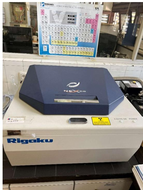
**Slika 14.** EDXRF spektrometar NEX CG
