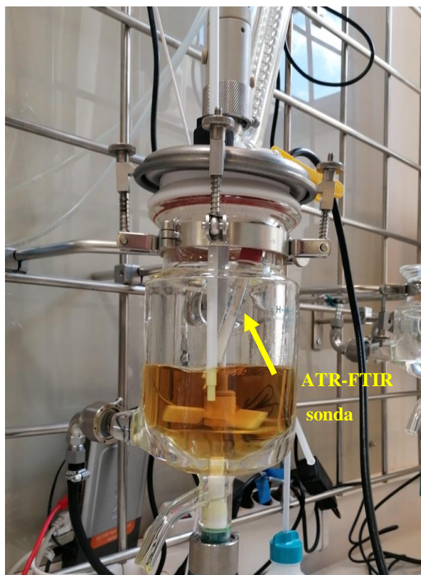
Slika 22. Kristalizator s plaštem, miješalom i ATR-FTIR sondom
