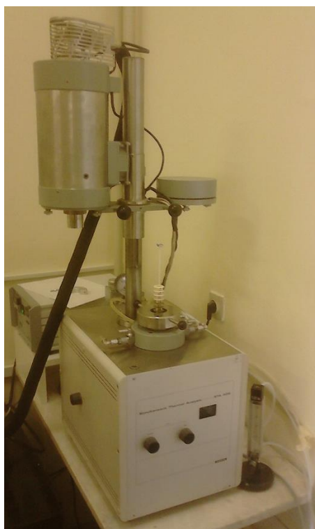
Slika 13. Fotografija Netzsch STA 409 uređaja
