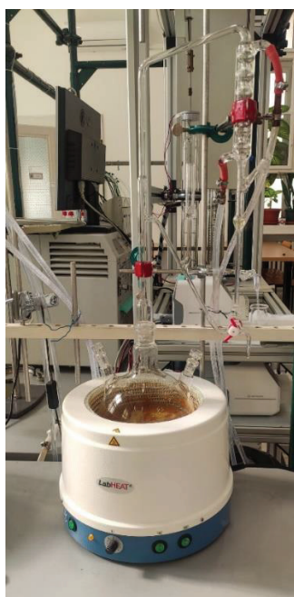
Slika 17. Aparatura po Clevengeru za hidrodestilaciju
