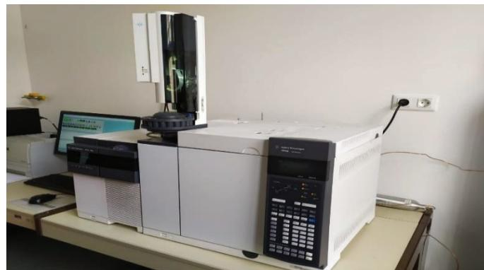
**Slika 23.** Plinski kromatograf sa spektrometrijom masa (GC-MS)
