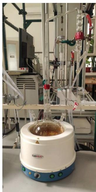
**Slika 17.** Aparatura po Clevengeru za hidrodestilaciju
