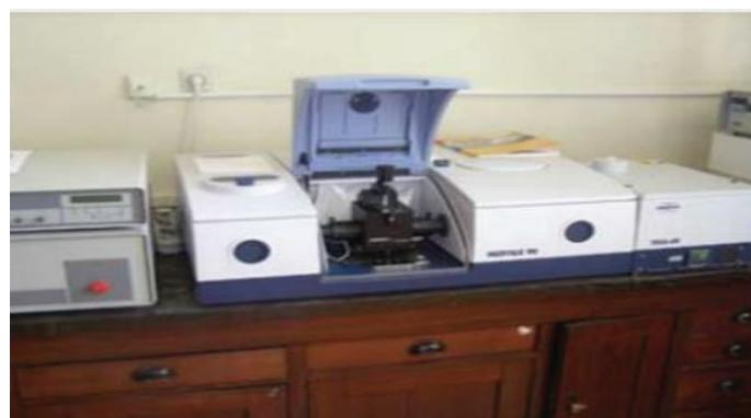
**Slika 24.** Infracrveni spektrofotometar s Fourierovom transformacijom signala
