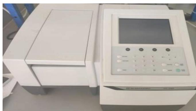
**Slika 25.** UV/Vis spektrofotometar
