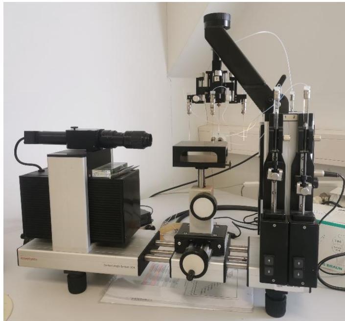
Slika 16. Instrument za mjerenje kontaktnog kuta DataPhysics OCA 20 Instruments
