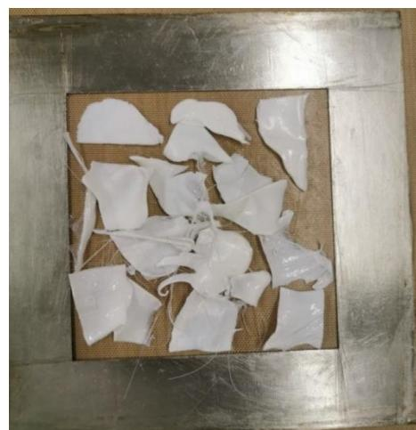
Slika 13. Priprava pločica u kalupu
