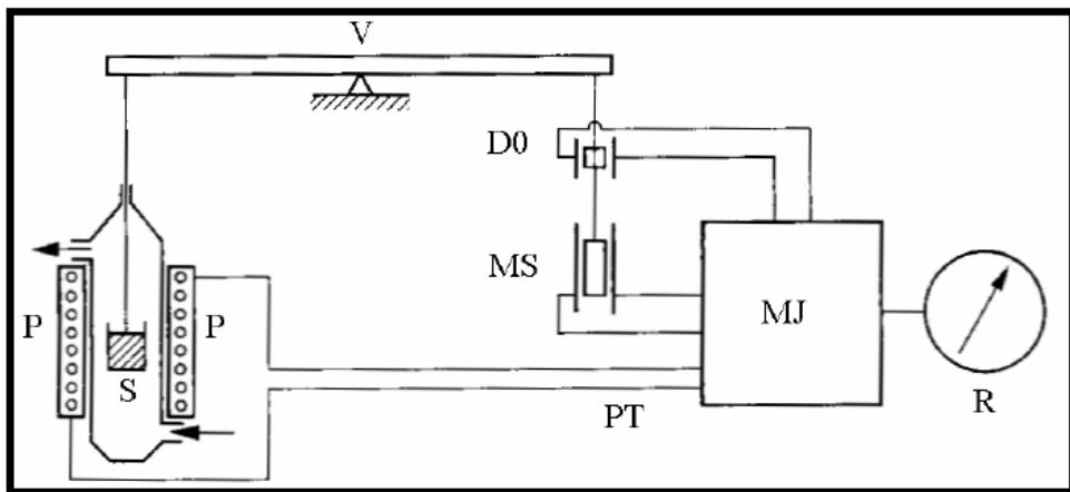
**Slika 9.** Shematski prikaz TG uređaja (V-vaga, S-uzorak, P-pećnica, PT-programiranje temperature, D0-detektor nulte točke, MS-magnetski svitak za kompenzaciju mase, MJ-modularna jedinica, R-registracijski uređaj) [24]
