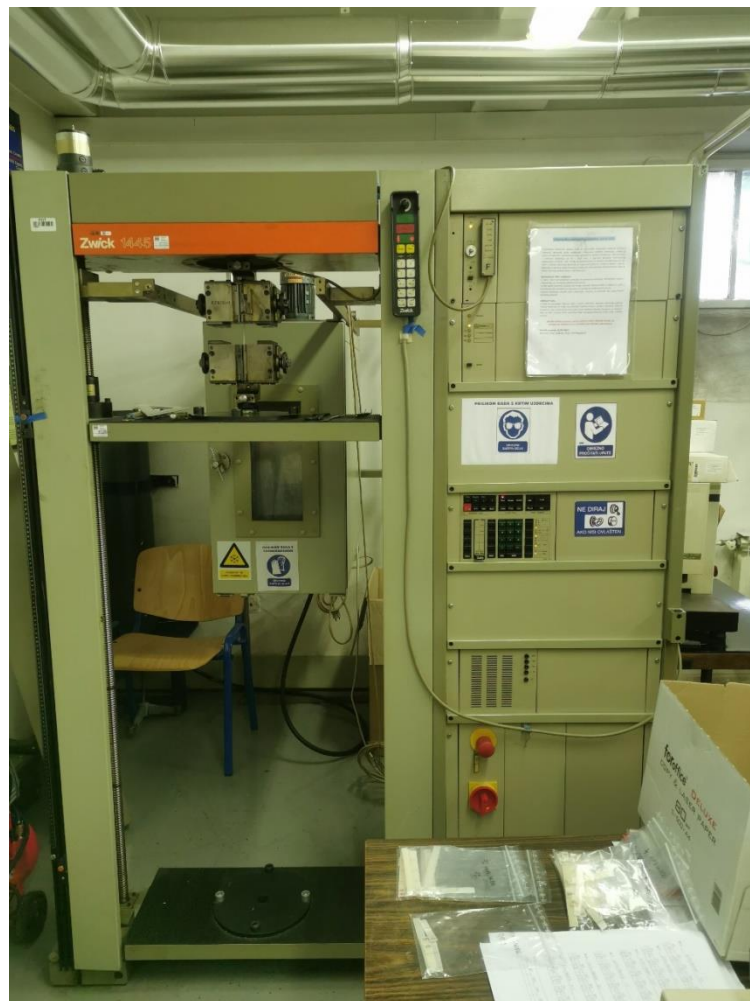
Slika 17. Mehanička kidalica Zwick 1445
