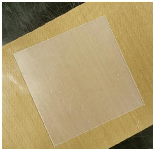
*Slika 15. Primjer pločice nakon hlađenja u kalupu*
