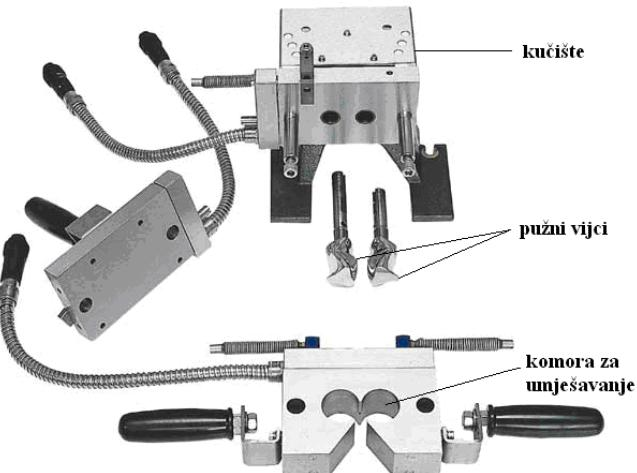
*Slika 11. Kućište Brabender gnjetilice [21]*
