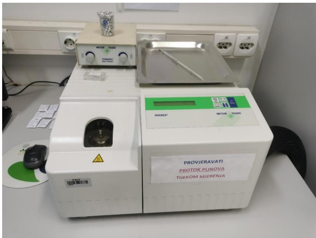
Slika 18. Diferencijalni pretražni kalorimetar, DSC - Mettler Toledo
