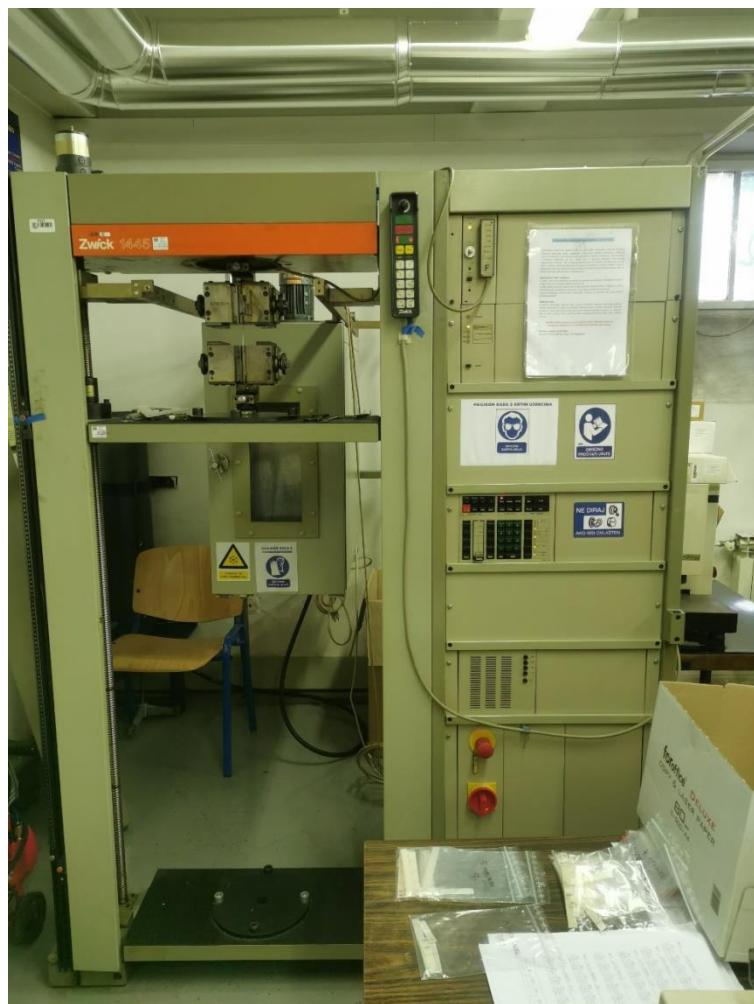
*Slika 17. Mehanička kidalica Zwick 1445*
