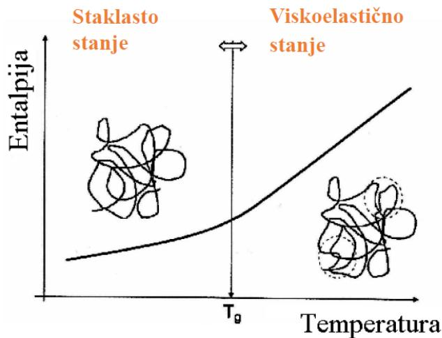
Slika 7. Prikaz DSC termograma za prijelaz iz staklastog u viskoelastično stanje
