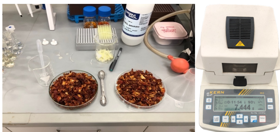
Slika 13. Pripremljeni uzorci čili papričica (lijevo); provedba infracrvenog sušenja čili papričica (desno).
