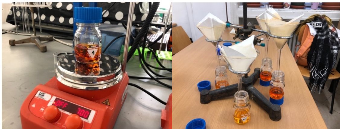
Slika 14. Provedba ekstrakcije kapsaicina uz magnetsko miješanje (lijevo), filtracija nakon ekstrakcije (desno).
