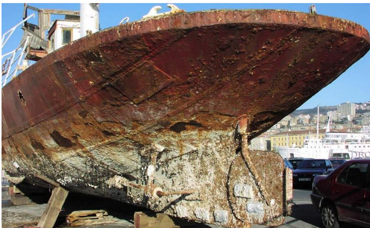
Slika 2. Šteta uzrokovana korozijom 5
