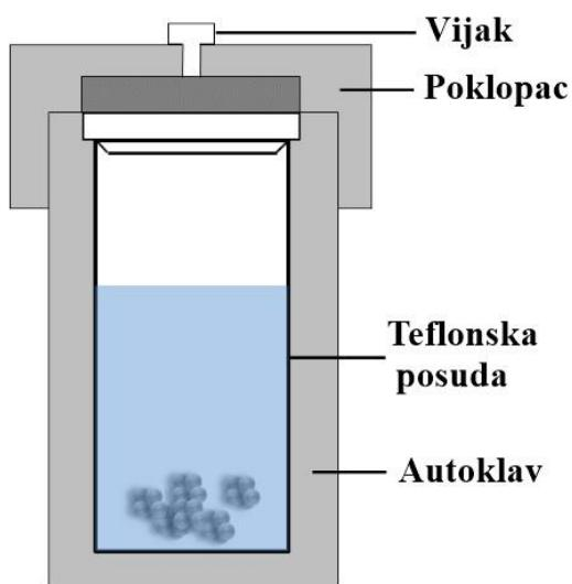
Slika 3. Aparatura za hidrotermalnu sintezu<sup>2</sup>
