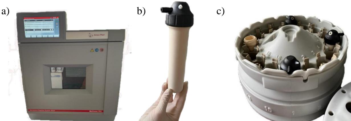
*Slika 7. Uredaj za mikrovalno potpomognutu sintezu (a) i njegovi dijelovi – teflonska kiveta (b) i keramički nosač (c)*
