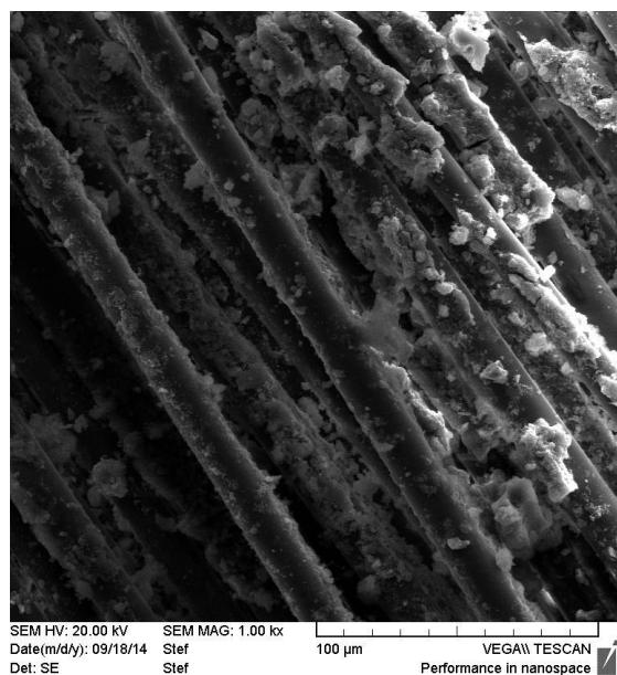
**Slika 21.** SEM snimke mrežice s TiO<sub>2</sub> nakon 3 dana ispiranja vodenim mlazom uvećane 1000 x
