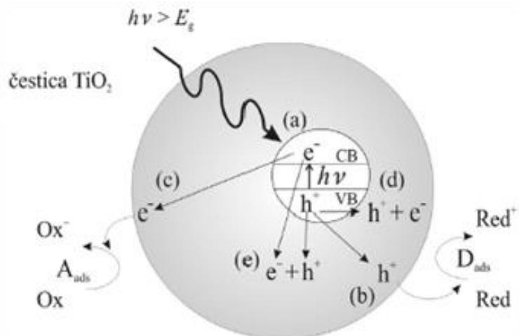
**Slika 1.** Glavni procesi u čestici poluvodiča  $\text{TiO}_2$ : (a) nastajanje para elektron-šupljina, (b) oksidacija adsorbirane molekule  $D$ , (c) redukcija adsorbirane molekule  $A$ , (d) rekombinacija na površini čestice, (e) rekombinacija u unutrašnjosti čestice
