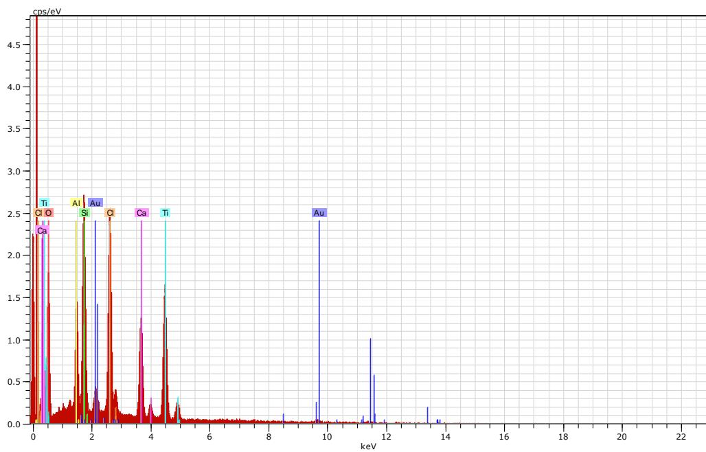
**Slika 19.** Rezultati EDS analize staklene mrežice s  $\text{TiO}_2$
