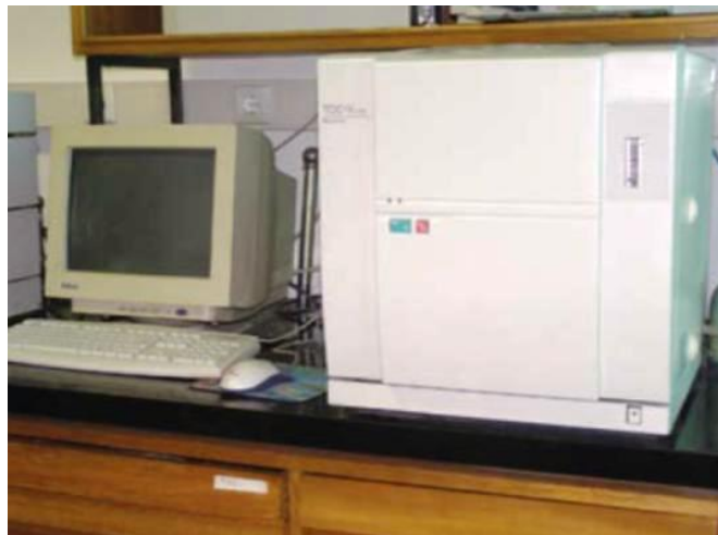
Slika 11. Instrument za mjerenje ukupnog organskog ugljika (Total Organic Carbon Analyzer)
