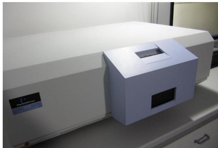
**Slika 9.** Fluorescentni spektrofotometar
