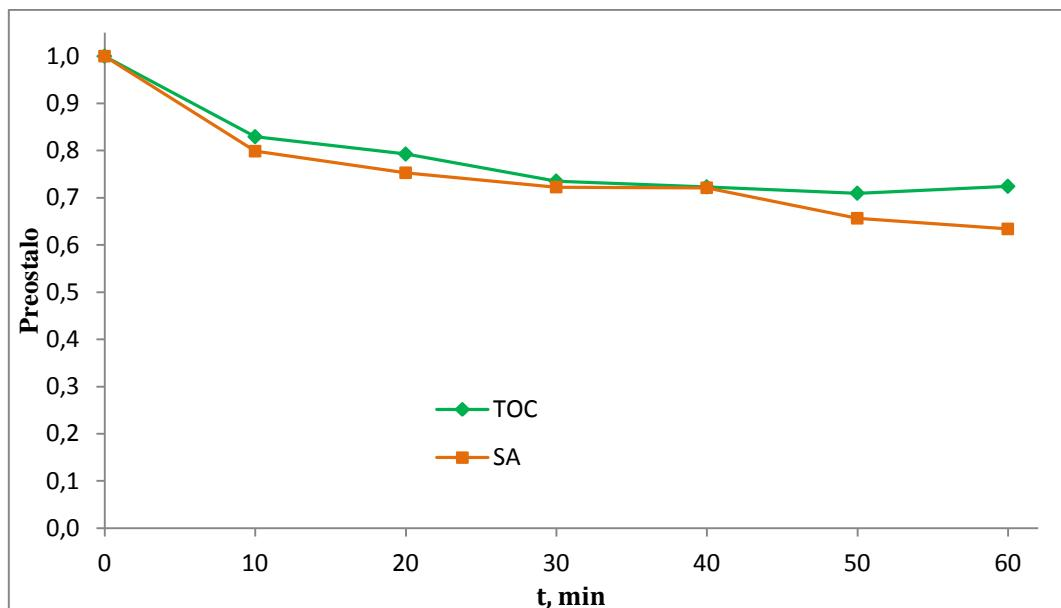
**Slika 26.** Fotokatalitička razgradnja SA u 100 ml otopine sa suspendiranim TiO<sub>2</sub> (0,1g/100ml) uz UV-A zračenje
