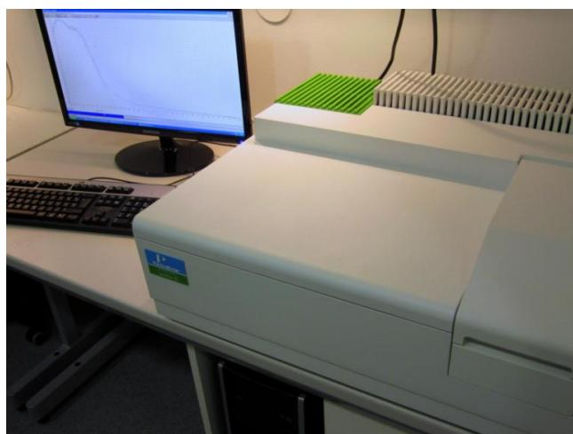
**Slika 8.** UV/VIS spektrofotometar
