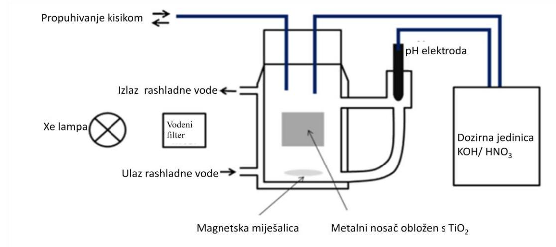
**Slika 7.** Shema fotoreaktora s  $\text{TiO}_2$  imobiliziranim na metalne nosače
