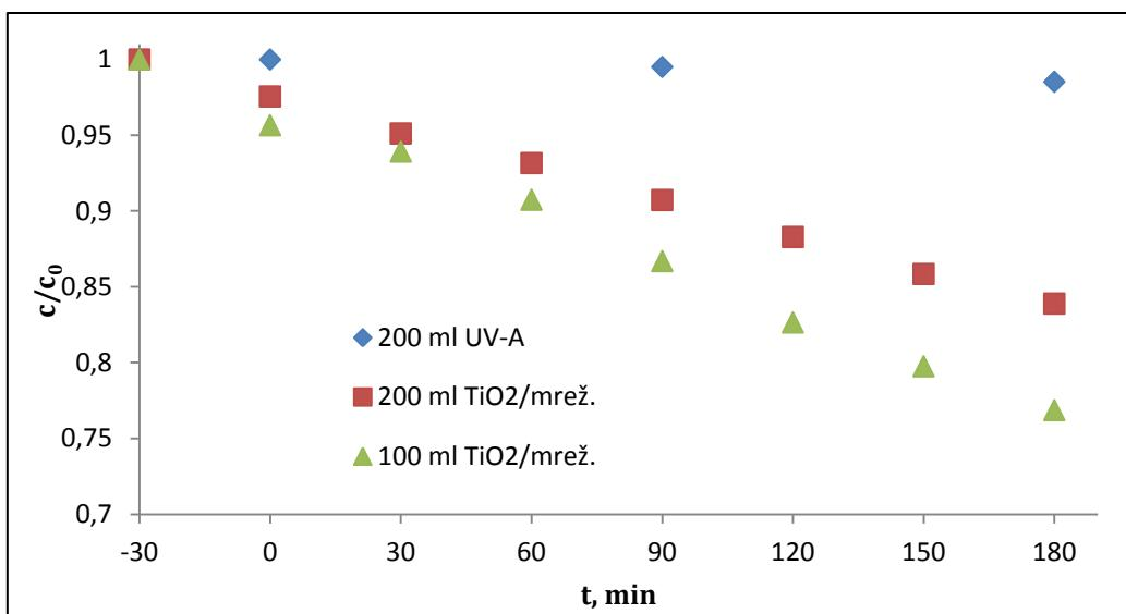
Slika 23. Razgradnja SA u 200 i 100 ml otopine s imobiliziranim  $\text{TiO}_2$  uz UV-A zračenje
