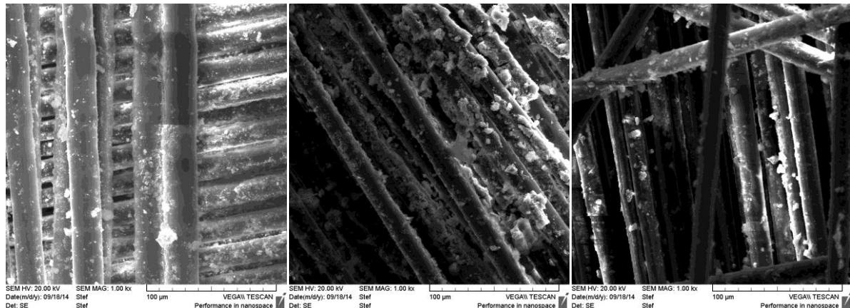
**Slika 20.** SEM slike staklenih mrežica s TiO<sub>2</sub> uvećane 1000 x
