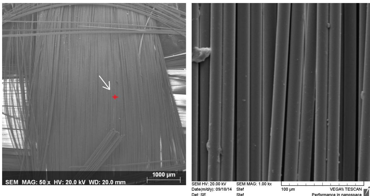
**Slika 16.** SEM snimka staklene mrežice bez  $\text{TiO}_2$  uvećana 50 i 1000 x
