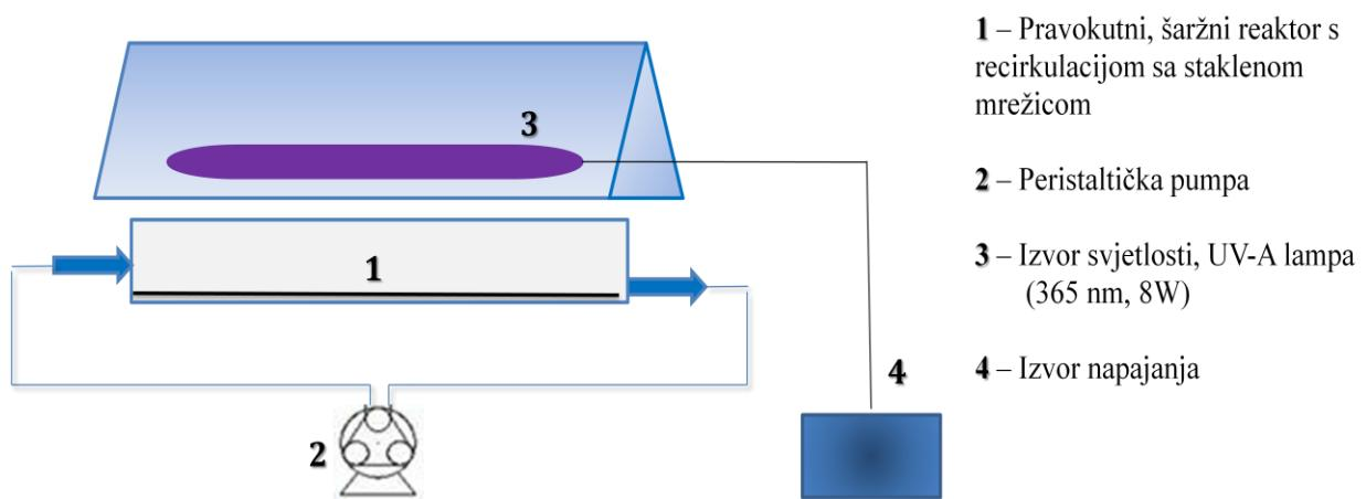
**Slika 12.** Shema fotoreaktorskog sustava
