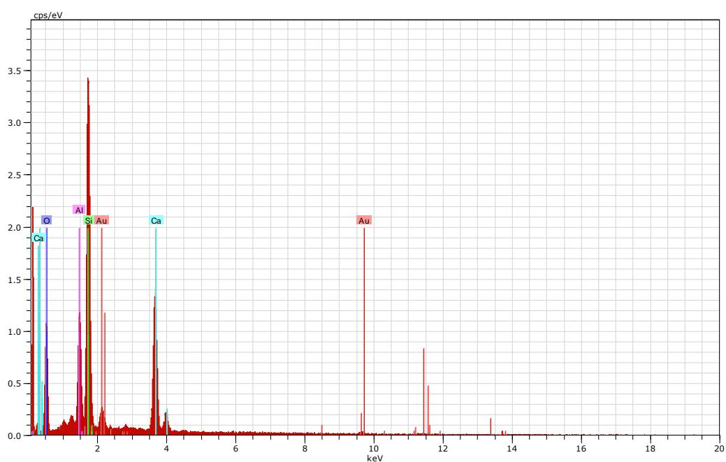
**Slika 17.** Rezultati EDS analize staklene mrežice bez  $\text{TiO}_2$
