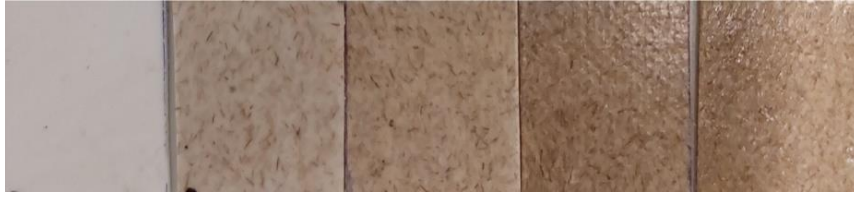
Slika 21. Pripremljene pločice PC-a ojačanog vlaknima brniste u udjelima od 5, 10, 15 i 20 mas. %
