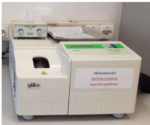
Slika 20. Diferencijalni pretražni kalorimetar *Mettler Toledo DSC 823e*
