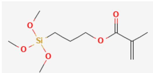
Slika 21. Struktura 3-metakriloksipropiltrimetoksisilana [76].
