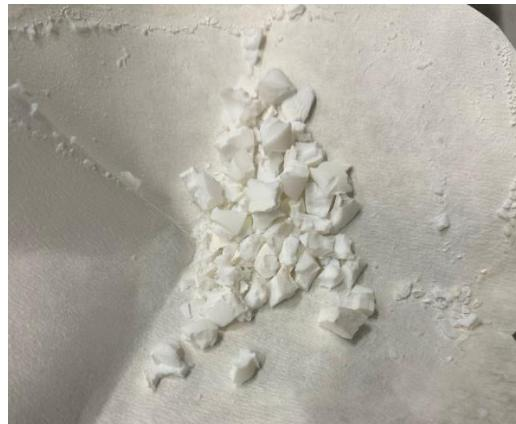
Slika 27. Izgled uzorka modificiranog GPTMS-om nakon sušenja.
