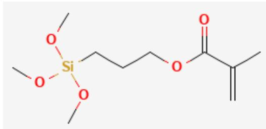
Slika 24. Struktura 3-metakriloksipropiltrimetoksisilana [83].
