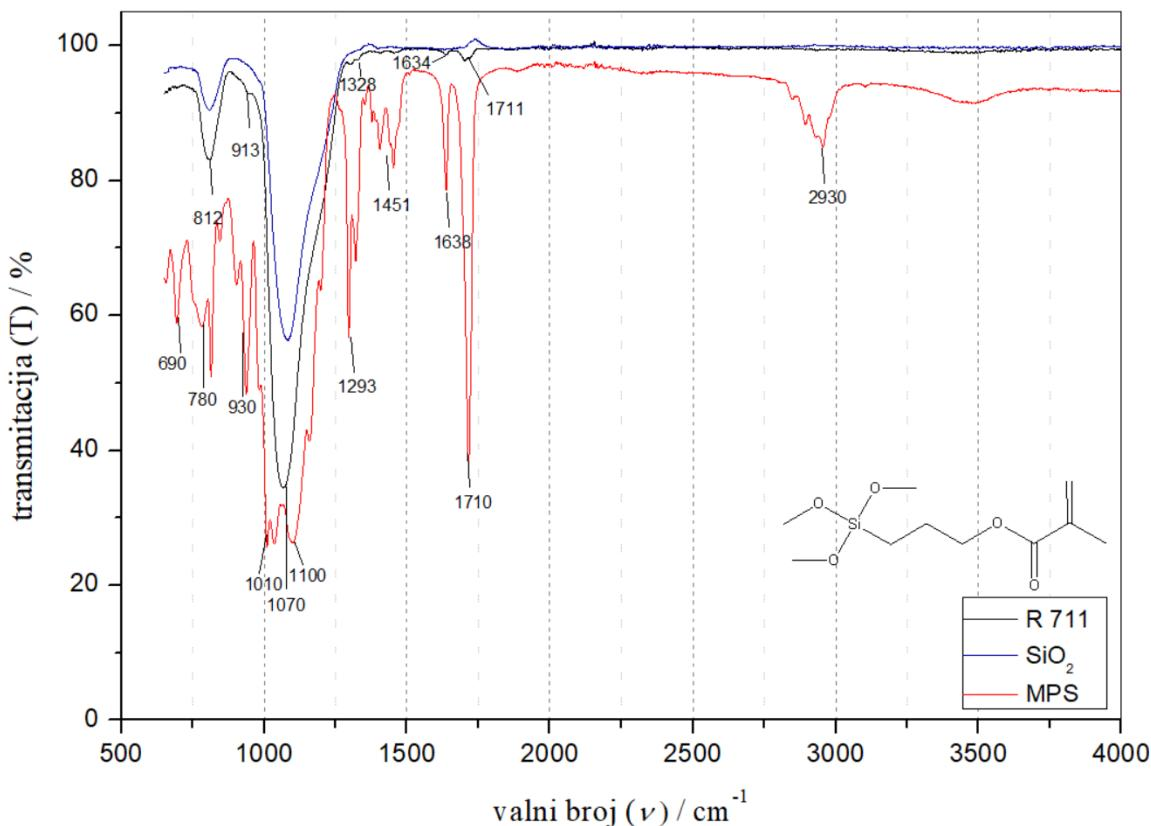
Slika 51. FTIR spektri čistog amorfognog  $\text{SiO}_2$ , MPS i R 711 (SiO<sub>2</sub> modificiranog s metakril silanom).
