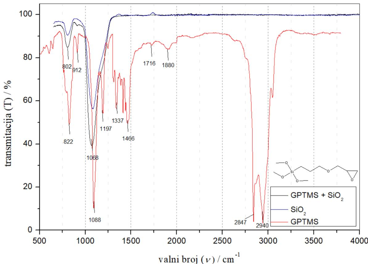
Slika 49. FTIR spektri čistog  $\text{SiO}_2$ , GPTMS [100] te  $\text{SiO}_2$  modificiranog s GPTMS silanom.
