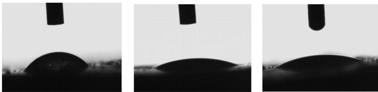
Slika 37. Kapljice testnih kapljevin (s lijeva na desno: voda, formamid, dijodometan) na tabletama punila MPS-om modificiranog amorfognog  $\text{SiO}_2$ .
