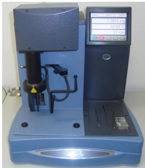
*Slika 33. Termogravimetar TA Instruments Q500.*
