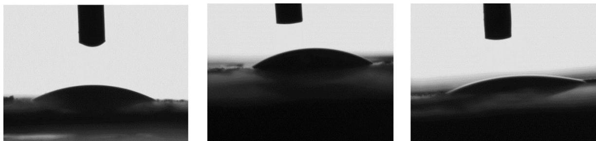
Slika 35. Kapljice testnih kapljevina (s lijeva na desno: voda, formamid, dijodometan) na tabletama punila APTS-om modificiranog amorfognog  $\text{SiO}_2$ .
