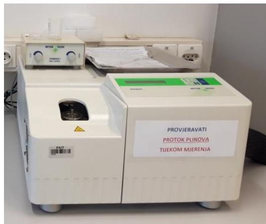
*Slika 32. Diferencijalni pretražni kalorimetar Mettler Toledo DSC 823e.*
