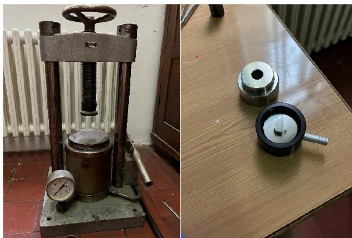
*Slika 29. Preša i kalup za tabletiranje.*
