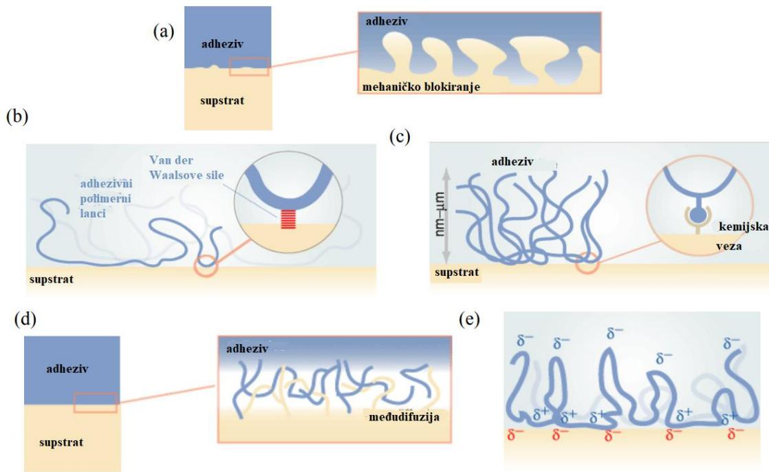
Slika 11. Pet vrsta prianjanja: a)mehaničko, b) adsorpcijsko, c) kemijsko, d) prianjanje difuzijom i e) elektrostatsko [34].
