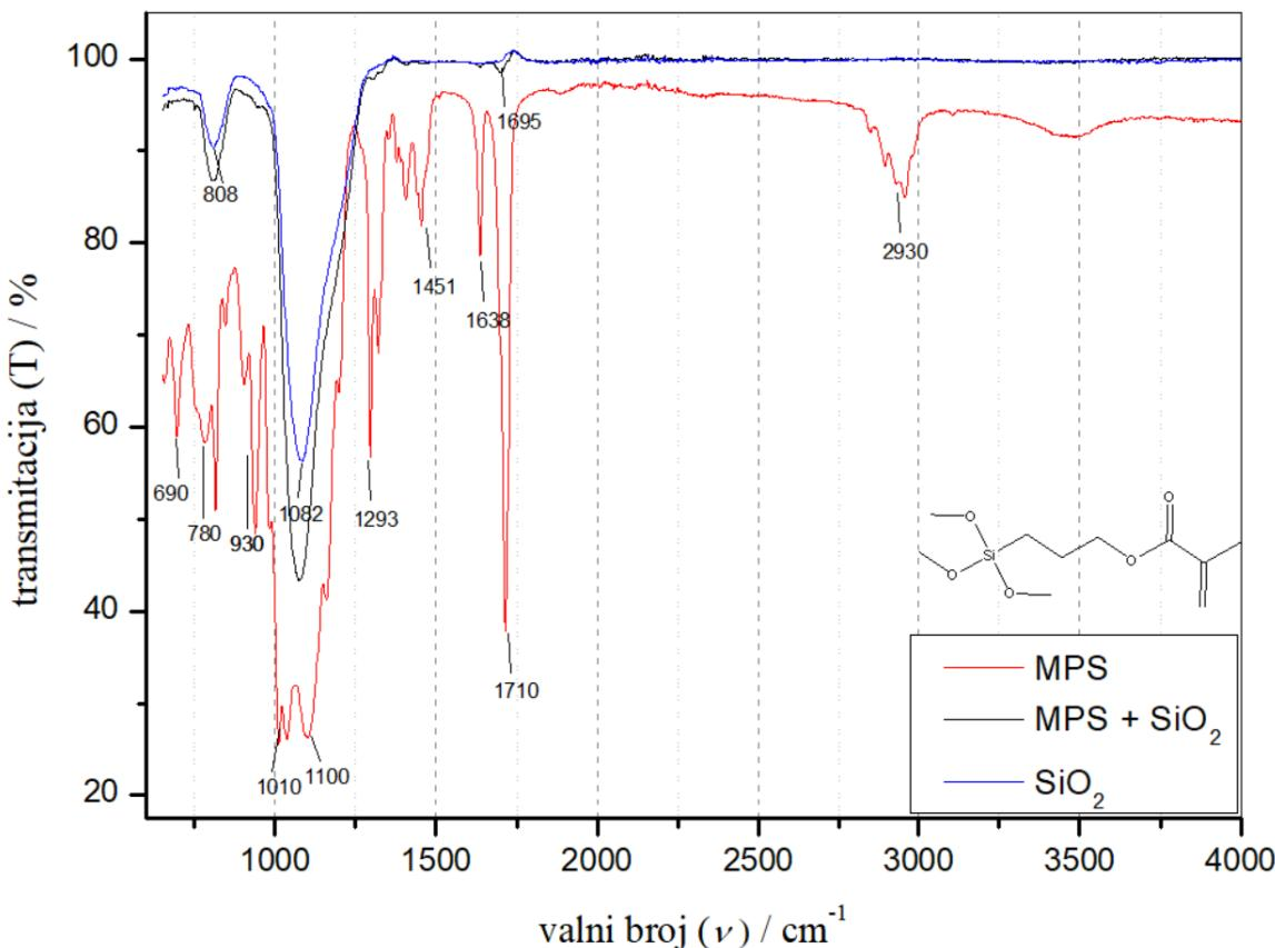
Slika 48. FTIR spektri čistog amorfognog  $SiO_2$ ,  $SiO_2$  modificiranog s MPS silanom te čistog MPS.
