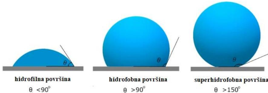
Slika 12. Shematski prikaz klasifikacije površina prema kontaktnom kutu [37].
