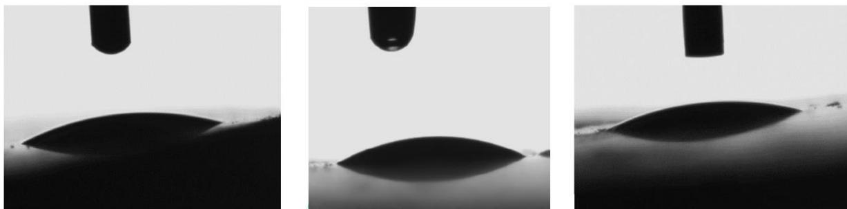
Slika 36. Kapljice testnih kapljevina (s lijeva na desno: voda, formamid, dijodometan) na tabletama punila APST-om modificiranog amorfognog  $\text{SiO}_2$ .
