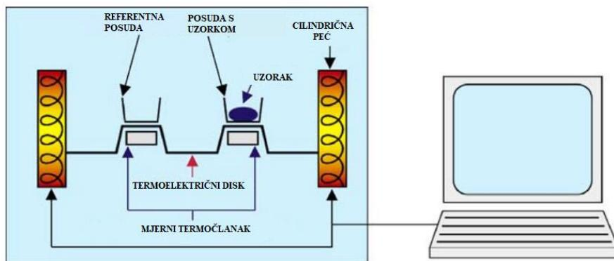
Slika 15. Shematski prikaz instrumentacije za DSC [54].
