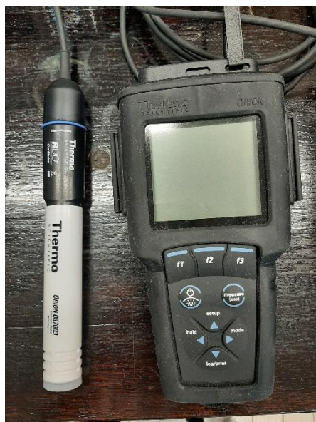
Slika 11. Kisikova elektroda Orion RDO Thermo Scientific, SAD
