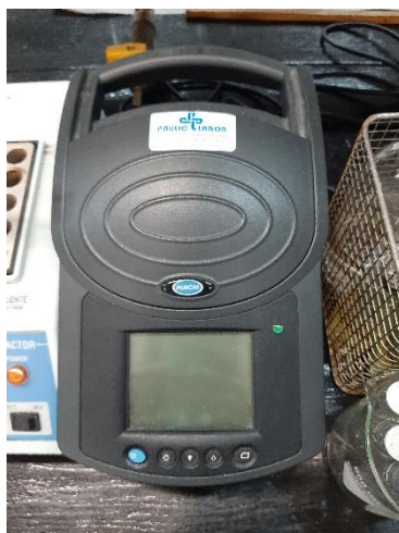
Slika 15. UV/VIS spektrofotometar DR 2400 HACH, SAD
