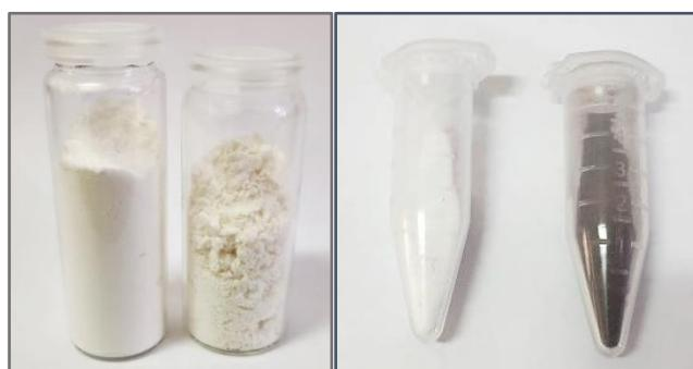
*Slika 5. Prikaz termički neobrađenih (lijevo) i termički obrađenih (800°C 2 h) uzoraka M@A0 i M@A4 (desno)*
