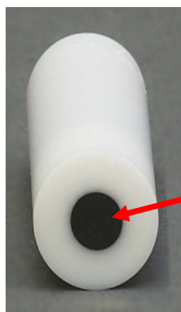
Slika 3.4. Prikaz elektroda s uzorkom grafena
