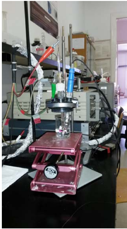
Slika 3.5. Aparatura za elektrokemijska ispitivanja
