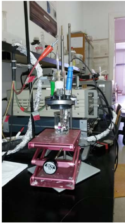
Slika 3.5. Aparatura za elektrokemijska ispitivanja
