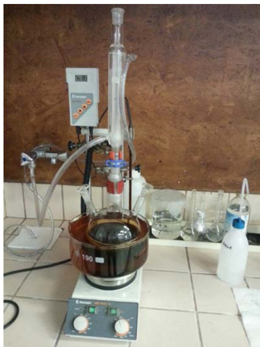
Slika 3.3. Aparatura u kojoj provedena redukcija grafena
