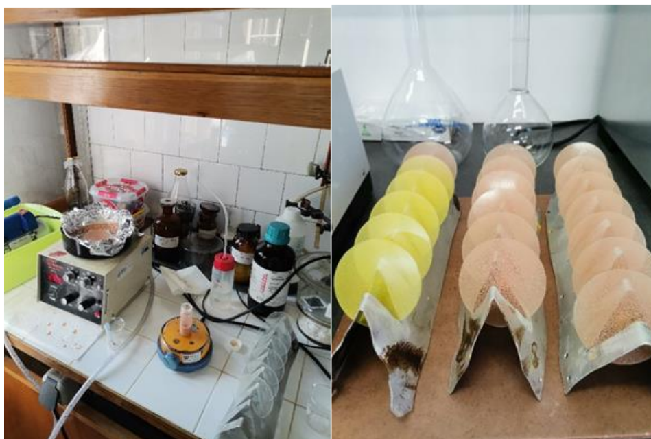
Slika 10. a) Postupak imobilizacije, b) imobilizirani fotokatalizator
