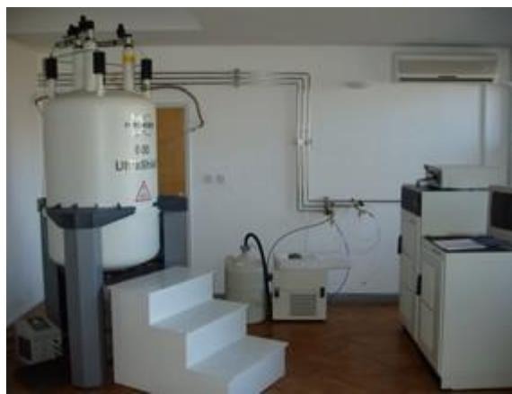
**Slika 3.7.** NMR instrument Bruker Avance 600 MHz<sup>8</sup>
