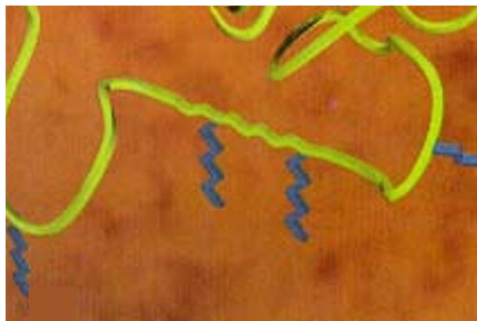
**Slika 2.5.** Polimerni aditiv s dugim bočnim alkilnim lancima (plavo); osnovni lanac polimernog aditiva (žuto)<sup>4</sup>
