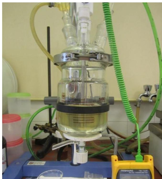
**Slika 3.5.** Reaktorski sustav za provedbu polimerizacije
