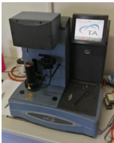
Slika 22. TA Instruments Q500 termogravimetar
