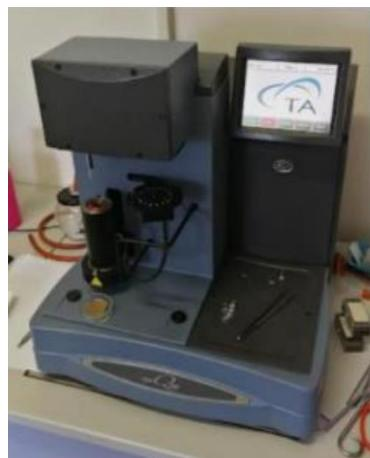
*Slika 22.* TA Instruments Q500 termogravimetar
