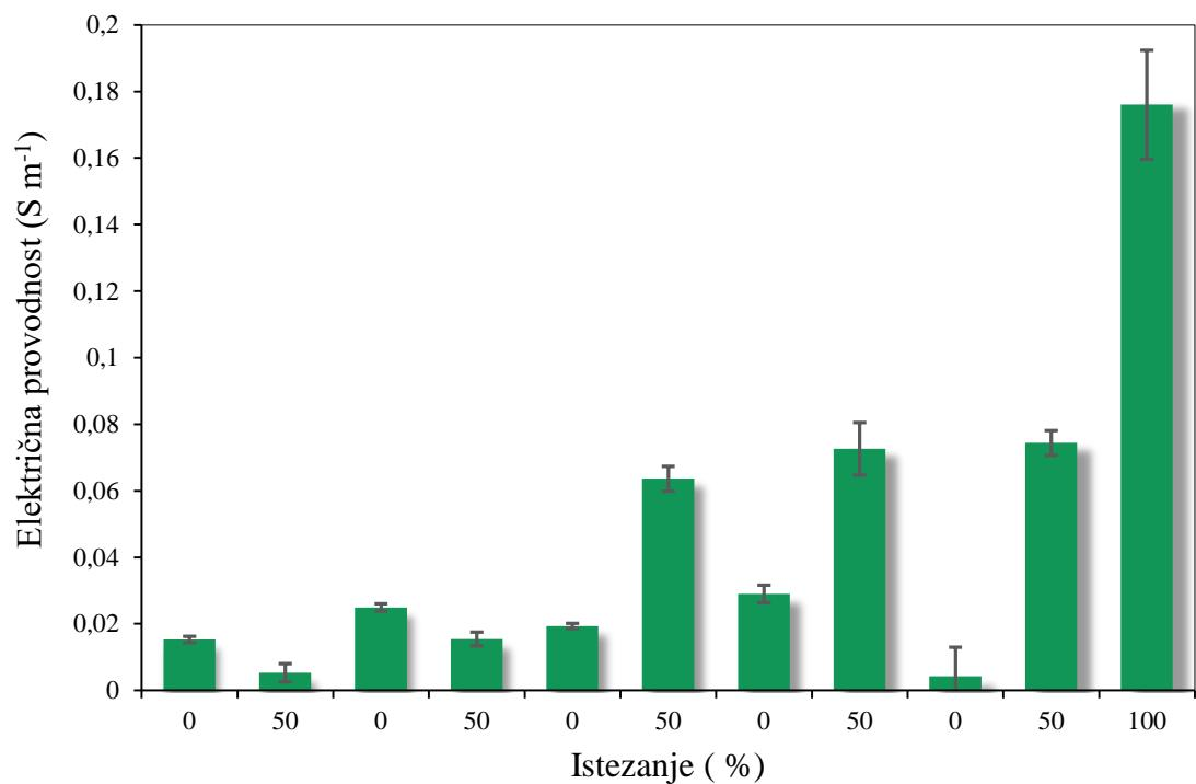
**Slika 46.** Ovisnost električne provodnosti o istezanju filma PEDOT-g-PAU:S-SEBS
