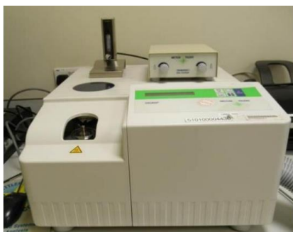
Slika 23. Mettler Toledo DSC 823eT kalorimetar
