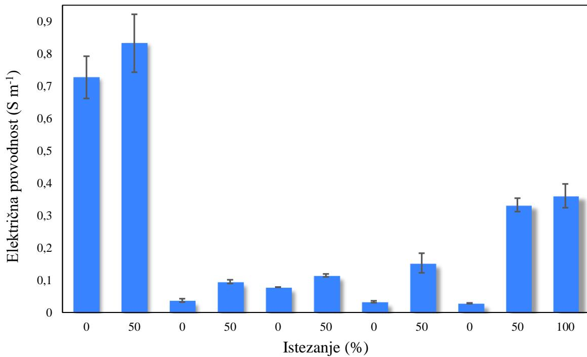
**Slika 45.** Ovisnost električne provodnosti o istezanju filma PEDOT-Br:S-SEBS
