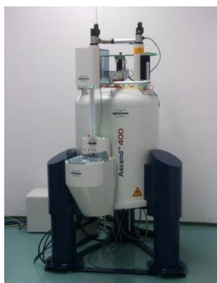
Slika 20. Bruker Avance III HD spektrometar
