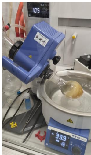
Slika 15. Otparivanje otapala na rotacijskom otparivaču
