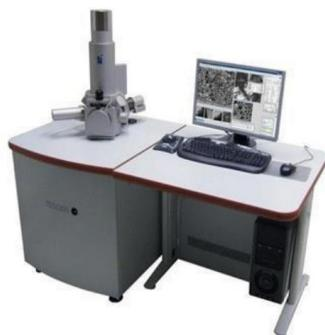
**Slika 25.** Pretražni elektronski mikroskop Tescan Vega 3
