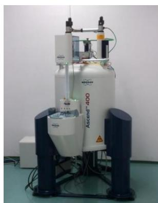
**Slika 20.** Bruker Avance III HD spektrometar
