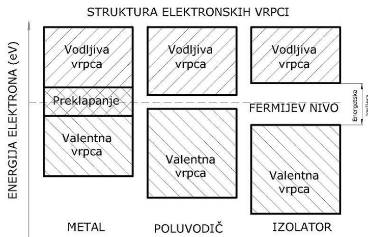
*Slika 2.* Usporedba elektronskih vrpcu kod metala, poluvodiča i izolatora [5]
