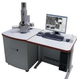
Slika 25. Pretražni elektronski mikroskop Tescan Vega 3
