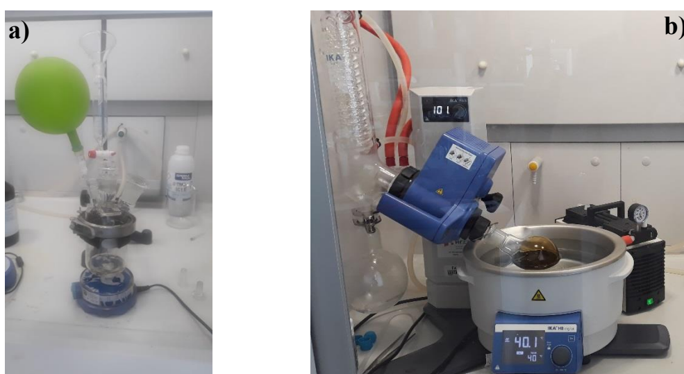
Slika 3.4. a) Sinteza PEDOT-Br makroinicijatora; b) rotacijski uparivač
