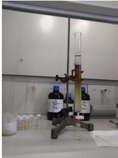
Slika 3.2. Kolonska kromatografija monomera ThBr-a
