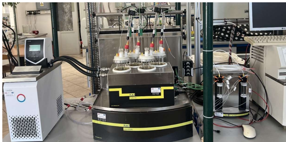
Slika 16. Uređaj CrystalSCAN korišten za provedbu procesa kristalizacije.
