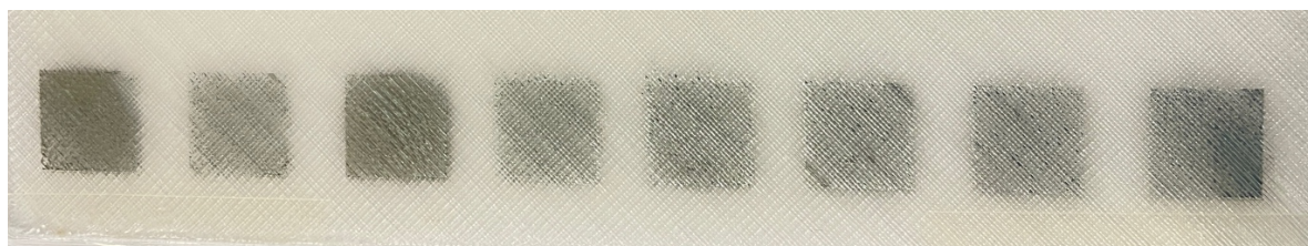
Slika 4.39. Ispis srebrne nanotinte na 3D-ispisanu PLA podlogu.
