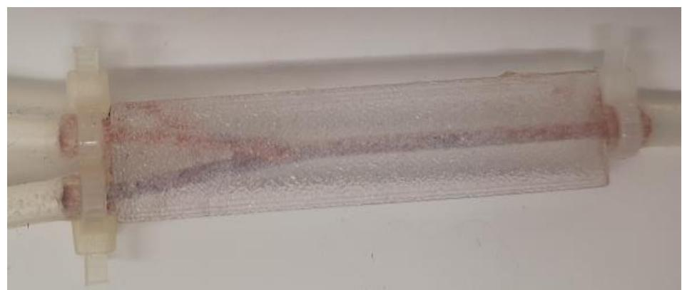
Slika 74. Mikroreaktor 80 s nakon početka protjecanja otopina (protok kiseline: 50  $\mu$ L/min; protok baze: 500  $\mu$ L/min).
