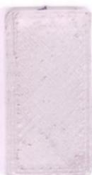
Slika 28. Pločica nakon 10 minuta u otopini: pH 11,0.
