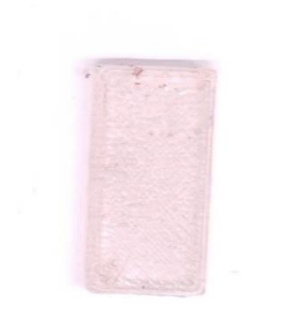
Slika 25. Pločica nakon 10 minuta u otopini: pH 8,1.
