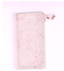
Slika 22. Pločica nakon 10 minuta u otopini: pH 5,0.
