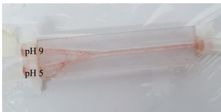
Slika 62. Mikroreaktor nakon 1 min od zamjene cjevčica i protjecanja otopina (pH 9 i pH 5).
