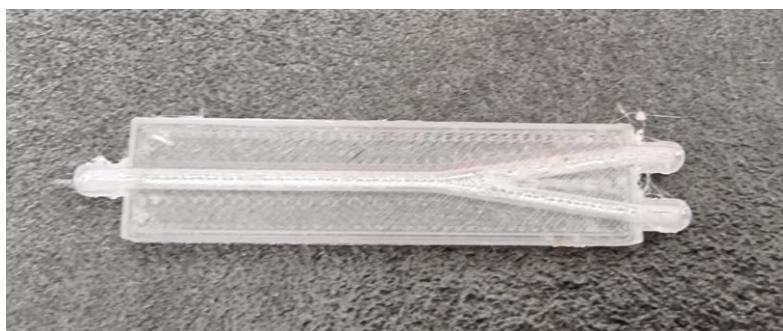
Slika 10. Mikroreaktor nakon izrade FFF tehnologijom ispisa.
