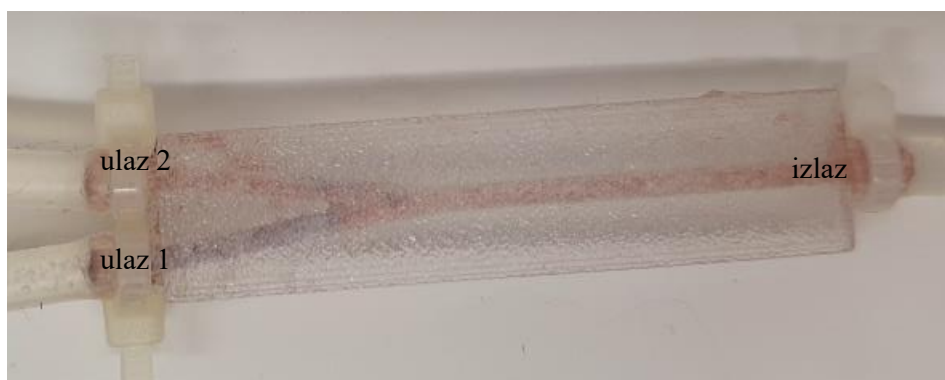
Slika 67. Mikoreaktor 10 s nakon početka protjecanja otopina (protok kiseline: 500 \mu\text{L}/\text{min} ; protok baze: 50 \mu\text{L}/\text{min} ).
