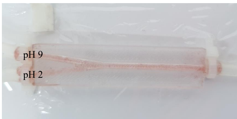
Slika 52. Mikroreaktor nakon 5 s od zamjene cjevčica i protjecanja otopina (pH 9 i pH 2).
