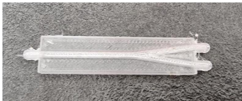
Slika 10. Mikroreaktor nakon izrade FFF tehnologijom ispisa.
