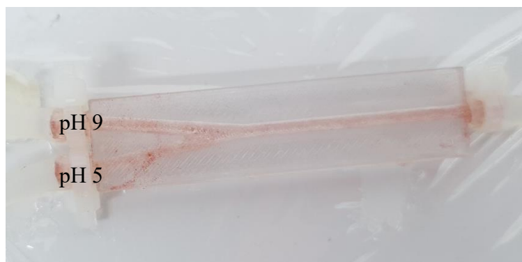
Slika 63. Mikroreaktor nakon 5 min od zamjene cjevčica i protjecanja otopina (pH 9 i pH 5).
