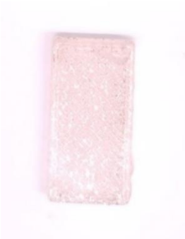
Slika 21. Pločica nakon 10 minuta u otopini: pH 4,0.
