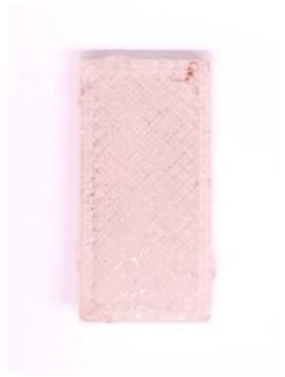
Slika 20. Pločica nakon 10 minuta u otopini: pH 3,1.
