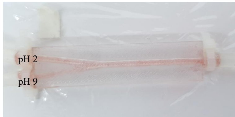
Slika 50. Mikroreaktor nakon 1 min protjecanja otopina (pH 2 i pH 9).
