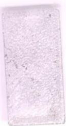
Slika 29. Pločica nakon 10 minuta u otopini: pH 12,0.
