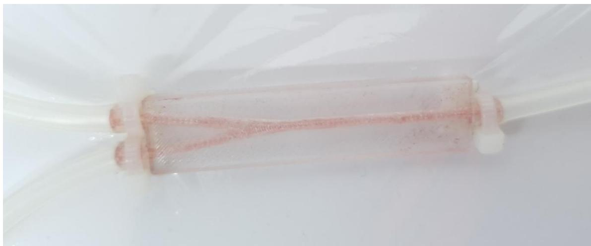
Slika 18. Prikaz ispitivanja filmova u kanalima mikroreaktora.
