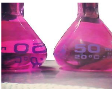
Slika 16. Prikaz obojenih otopina za određivanje nitrita
