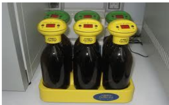
Slika 10 Prikaz boca i zatvarača metode OXITOP
