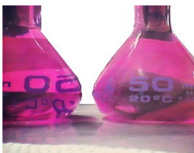
Slika 16. Prikaz obojenih otopina za određivanje nitrita
