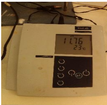
Slika 7. pH-metar WTW inoLab
