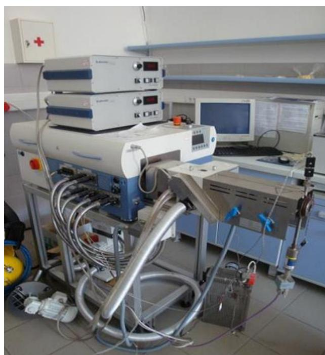
**Slika 28.** Laboratorijski jednopužni ekstruder Brabender 19/20 DN
