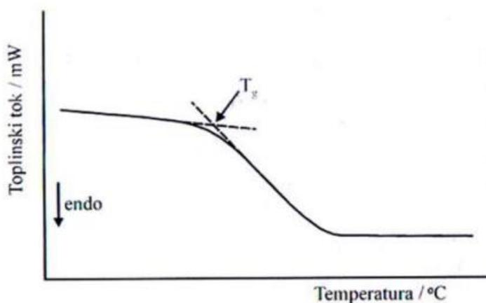
**Slika 21.** Određivanje staklišta na DSC termogramu [77]
