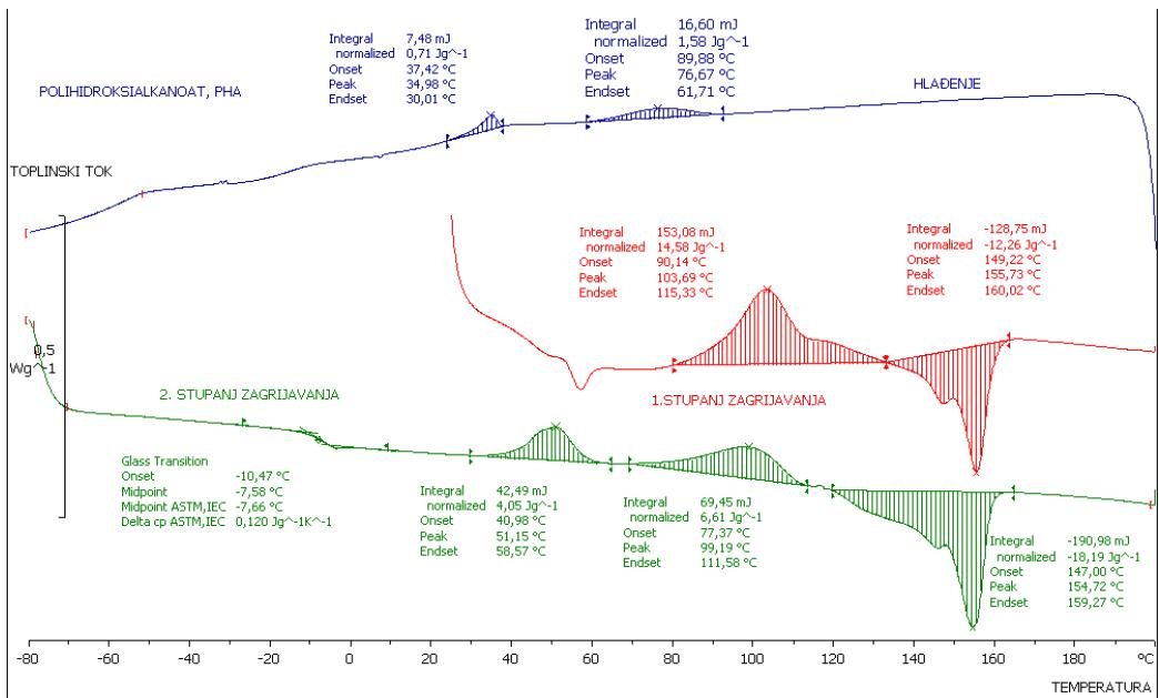
**Slika 47.** DSC termogram čistog PHA polimera
