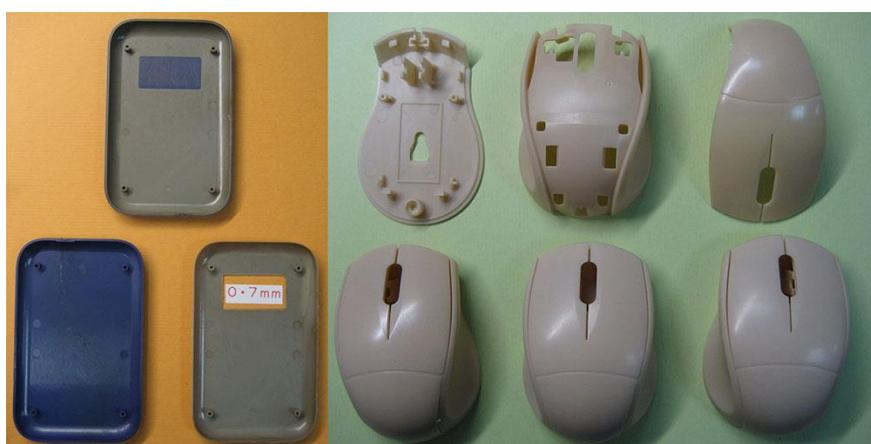
**Slika 9.** Elektronska kućišta izrađena od biomase na bazi škroba [38]
