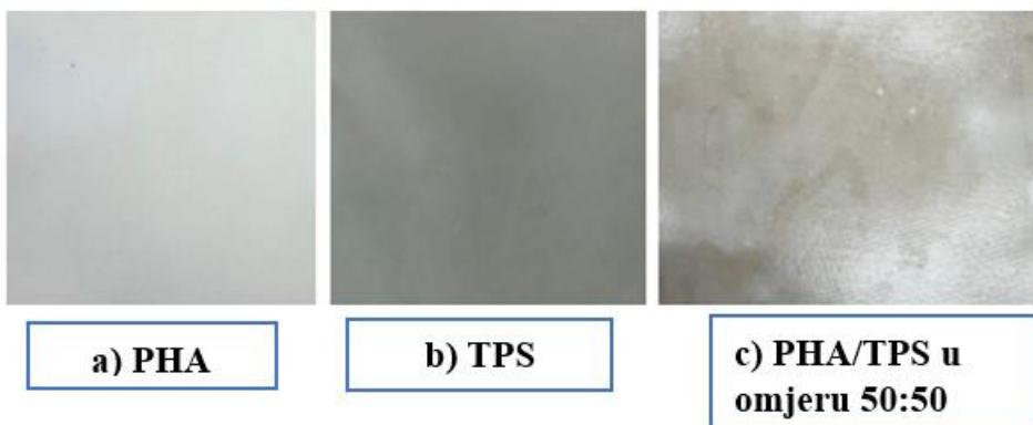
**Slika 35.** Pripremljeni filmovi čistih polimernih materijala PHA i TPS te njihove polimerne mješavine PHA/TPS
