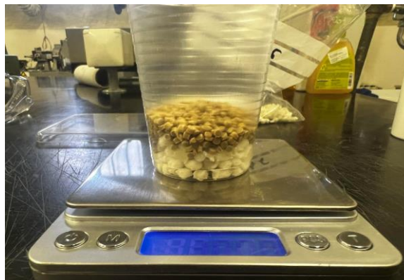
Slika 30. Odvagana masa polimerne mješavine PHA /TPS u plastičnoj čaši
