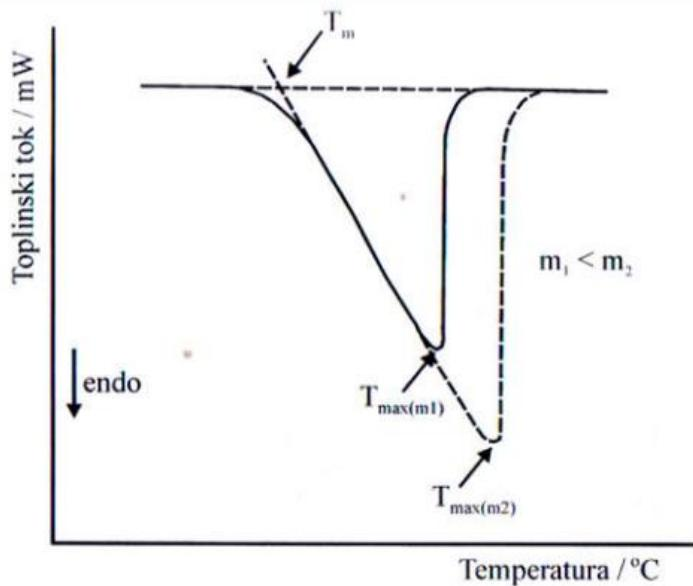
**Slika 22.** Određivanje temperature tališta na DSC krivulji [77]
