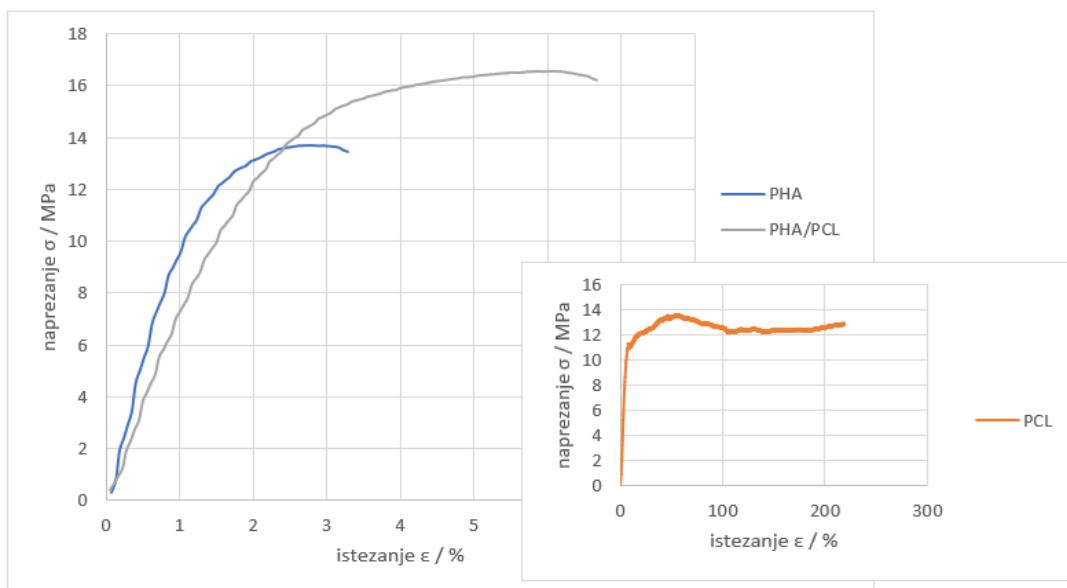
**Slika 56.** Grafički prikaz ovisnosti naprezanja o istezanju za čisti PHA i PCL te polimernu mješavinu PHA/PCL
