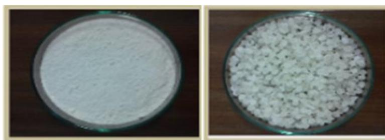
**Slika 27.** Prirodni pšenični škrob (lijevo) i granule termoplastičnog škroba (desno)
