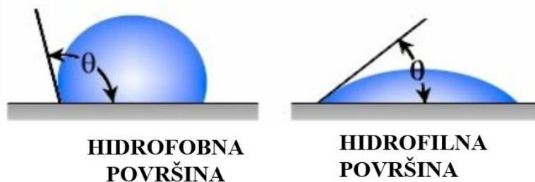
*Slika 25.* Prikaz kontaktog kuta za hidrofilnu i hidrofobnu površinu [82]
