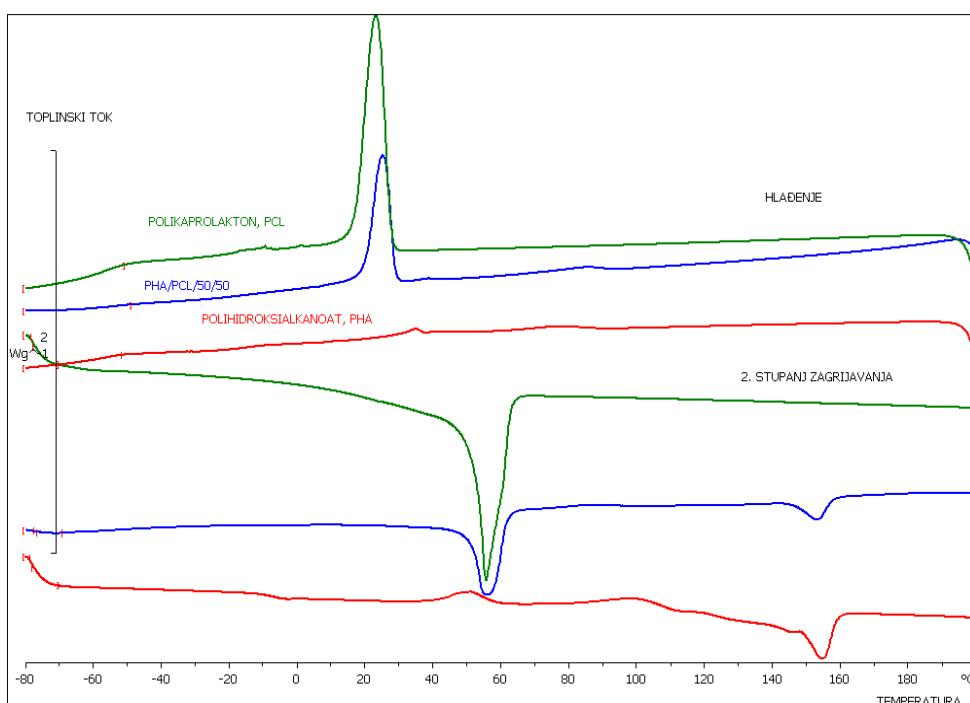
**Slika 51.** DSC termogrami čistog PHA i PCL te polimerne mješavine PHA/PCL
