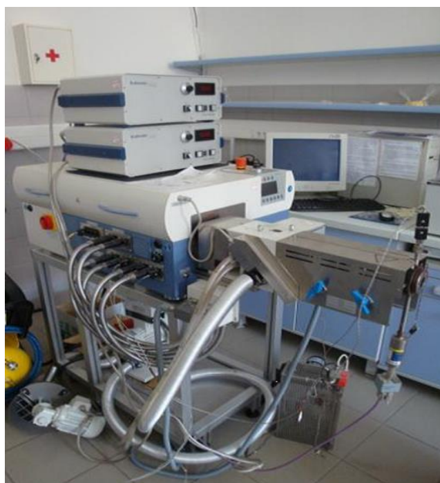
Slika 28. Laboratorijski jednopužni ekstruder Brabender 19/20 DN
