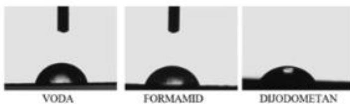
Slika 40. Kapljice testnih kapljevin na čistim polimernim materijalima PCL, PLA, TPS i PHA
