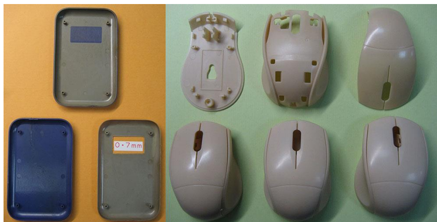
Slika 9. Elektronska kućišta izrađena od biomase na bazi škroba [38]
