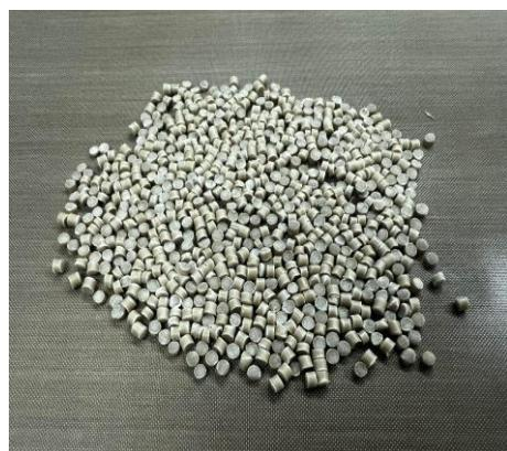
*Slika 26.* Granule polihidroksialkanoata (PHA)
