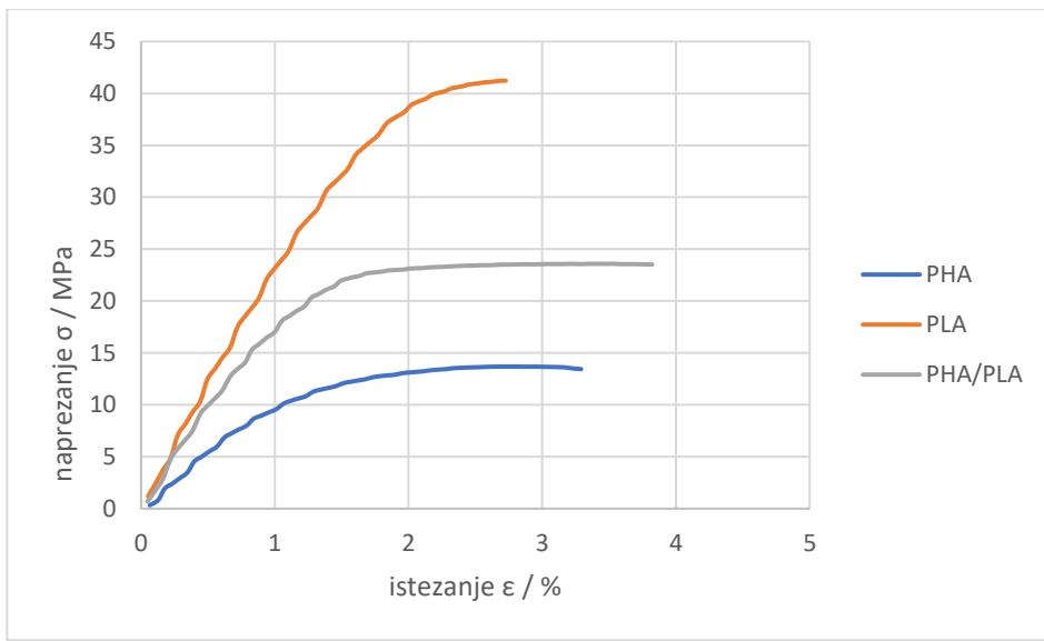
**Slika 55.** Grafički prikaz ovisnosti naprezanja o istezanju za čisti PHA i PLA te polimernu mješavinu PHA/PLA
