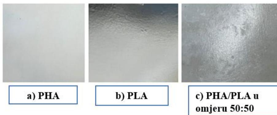
**Slika 33.** Pripremljeni filmovi čistih polimernih materijala PHA i PLA te njihove polimerne mješavine PHA/PLA
