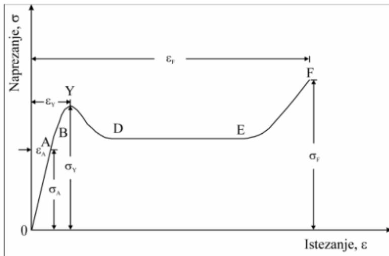
**Slika 24.** Opći oblik krivulje naprezanje-istezanje [79]
