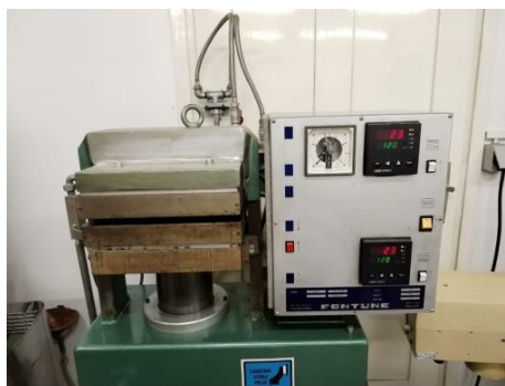
Slika 30. Hidraulička preša Fortune, Holland (SRB 140, EC 320x320NB)
