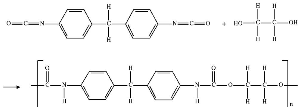
Slika 2.7 Molekularna struktura PU
