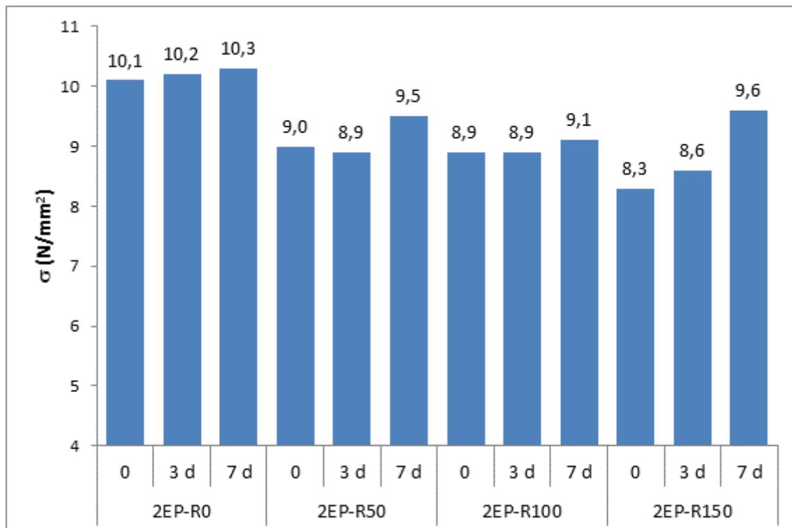
Slika 4.2 Prekidna čvrstoća ( $\sigma$ ) 2.serije ispitivanih uzoraka nakon 3 i 7 dana starenja u vrućem zraku na  $100^\circ C$
