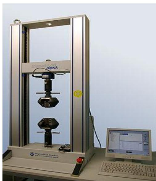
Slika 3.1 Univerzalna kidalica, metoda naprezanje-istezanje
