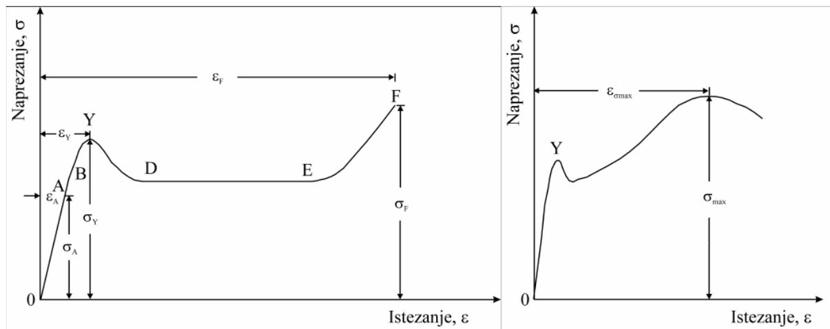
Slika 2.13 Opći oblik krivulje rastezno naprezanje-istezanje i krivulja s istaknutom rasteznom čvrstoćom ( $\sigma_{\max}$ ); 0A-područje proporcionalnosti, 0B-područje elastičnosti, Y-granica popuštanja, DE-područje hladnog razvlačenja, F-kidanje materijala
