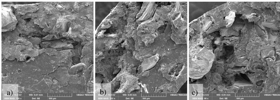
Slika 4.15 SEM mikroografi 3. serije uzoraka: a) 3EP-R25, b) 3EP-R50, c) 3 EP-R100
