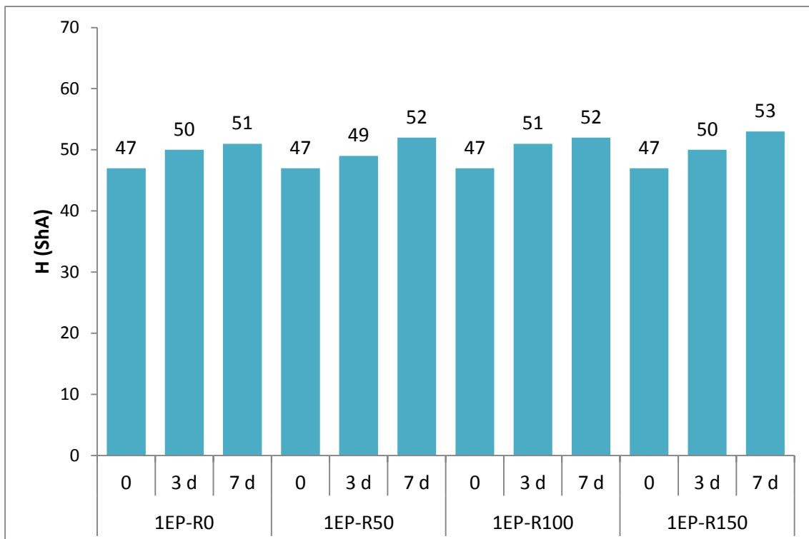
Slika 4.7 Tvrdoća H [ShA] 1.serije ispitivanih uzoraka nakon 3 i 7 dana starenja u vrućem zraku na 100 °C
