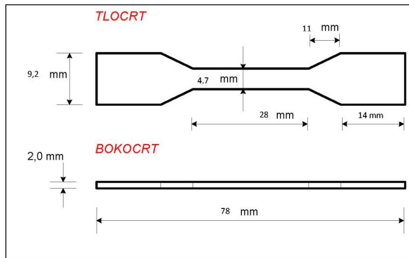
Slika 2.12 Epruveta za rastezno ispitivanje
