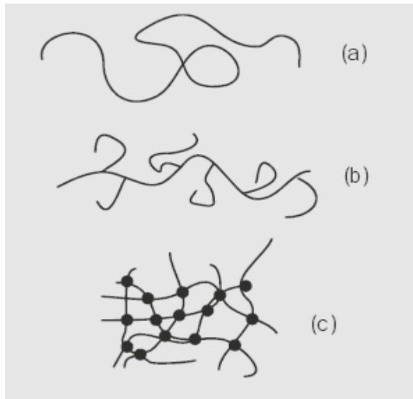
Slika 2.2 Klasifikacija polimera prema makroskopskoj strukturi: a) linearani polimer, b) razgranati polimer, c) umreženi polimer
