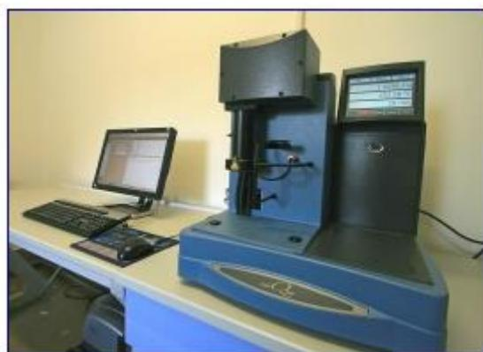
Slika 3.3 Termogravimetar *TA Instruments Q500*
