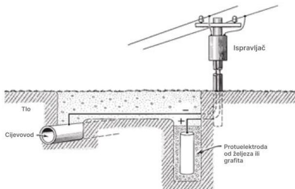
**Slika 2.11.** Prikaz katodno zaštićene cijevi s protuelektrodom (anodom) i ispravljačem (izvor struje) <sup>[4]</sup>
