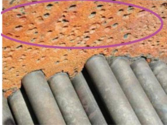
**Slika 2.6.** Jamičasta korozija (eng. *pitting*) na ugljičnom čeliku izmjenjivača topline <sup>[1]</sup>
