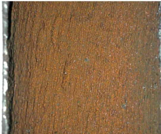
**Slika 2.9.** Primjer erozijske korozije unutar cijevi izrađene od ugljičnog čelika za skladištenje ukapljenog naftnog plina (uočava se karakteristična hrapava površina s nejednolikom debljinom) [2]
