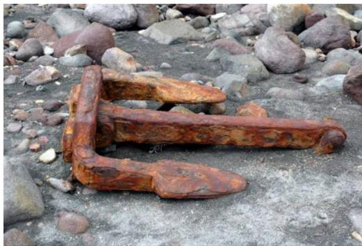
Slika 2.1. Prikaz jednolike korozije na sidru izložen morskoj vodi <sup>[2]</sup>
