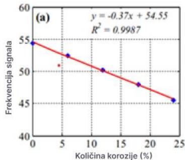
Slika 3.3. Ovisnost frekvencije prvog signala o količini korozije <sup>[5]</sup>
