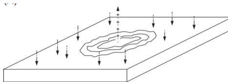
Slika 2 2. Shematski prikaz lokalizirane korozije <sup>[1]</sup>
