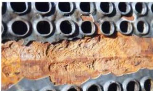
**Slika 2.3.** Prikaz galvanske korozije na čeličnom limu izazvan velikom katodnom području (admiralne brončane cijevi) i anodnog područja (ugljični čelik s epoxy prevlakom); sivo područje predstavlja neuspjeli epoksidni premaz, a narančasto područje predstavlja korodirani sloj lima <sup>[2]</sup>
