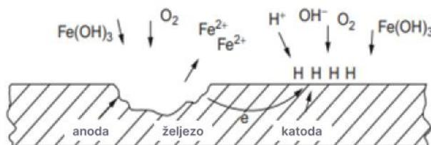
**Slika 2.7.** Mehanizam napada kisika na ugljični čelik <sup>[1]</sup>
