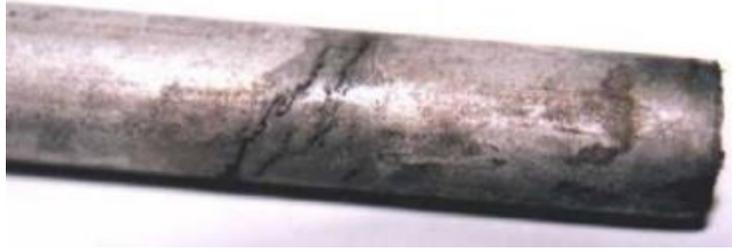
**Slika 2.10.** SCC korozija cijevi izrađene od nehrđajućeg čelika (SS 316) izložen atmosferi koji sadrži plinovitu klorovodičnu kiselinu <sup>[2]</sup>
