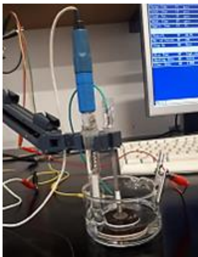
Slika 3.7. Aparatura korištena za redukciju GO papira.
