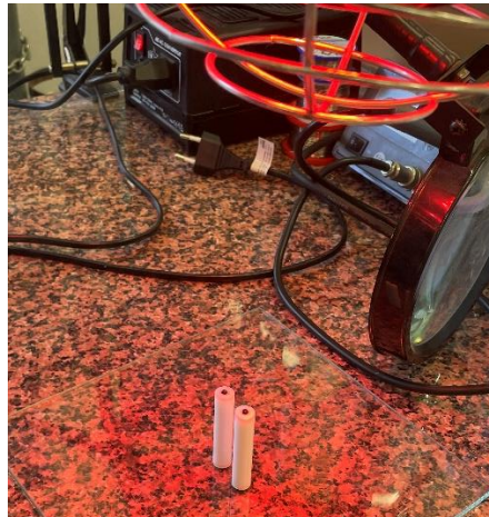
Slika 3.1. Sušenja GC elektroda na koje je nanesen alikvot otopine GO pod IR lampom.
