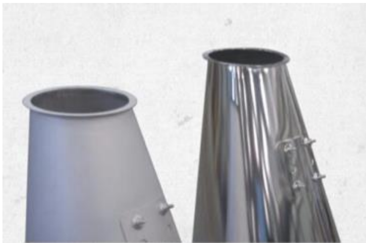
Slika 8. Prikaz nehrđajućeg čelika prije i poslije elektropoliranja [9]
