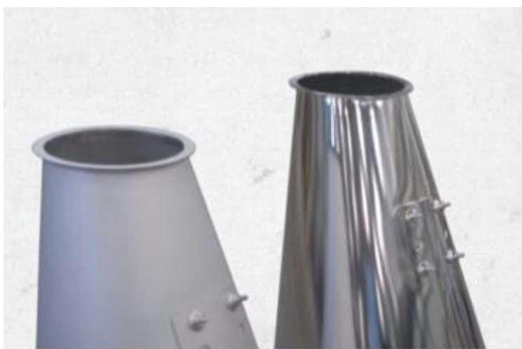
Slika 8. Prikaz nehrđajućeg čelika prije i poslije elektropoliranja [9]
