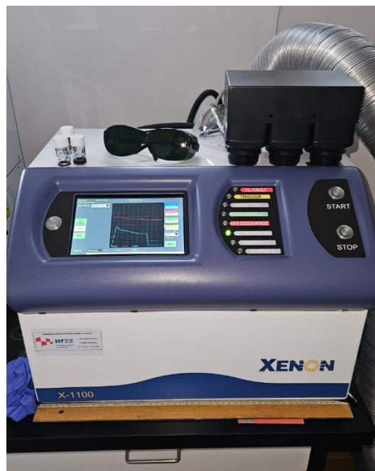
Slika 15. IPL sustav XENON X-1100.
