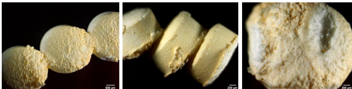
Slika 29. Stereomikrografije: sparene tablete –eksperimenti B4 i B5
