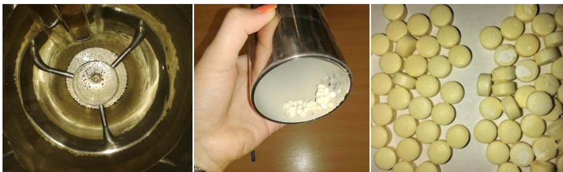
Slika 24. Izgled unutrašnjosti komore za oblaganje; lijepljenje za Wursterovu cijev; odvojene dobro i loše obložene tablete
