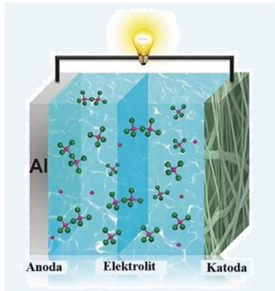
Slika 2.7.1. Shematski prikaz aluminij-ionske baterije. [15]
