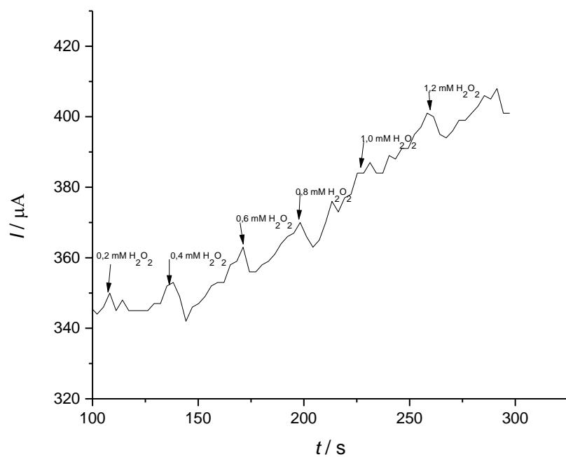
Slika 26. Kronoamperometrijski prikaz dodatka 0,1 M otopine  $\text{H}_2\text{O}_2$  u fosfatni pufer (pH = 6,1) na plošnoj elektrodi uz miješanje pri potencijalu – 0,1 V.
