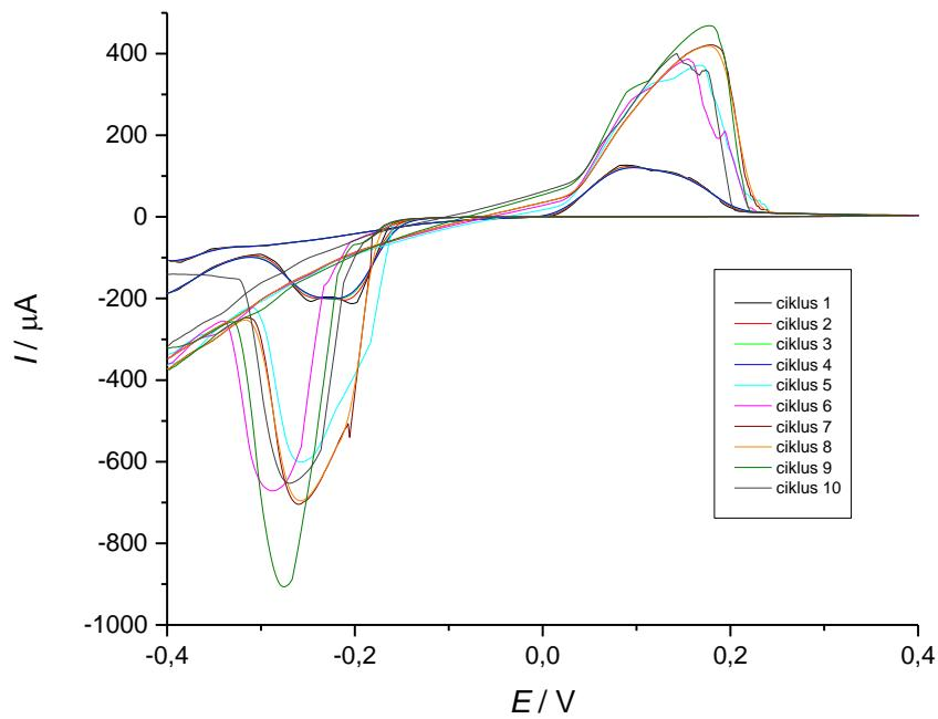
Slika 25. Aktivacija PB sloja na plošnoj elektrodi.
