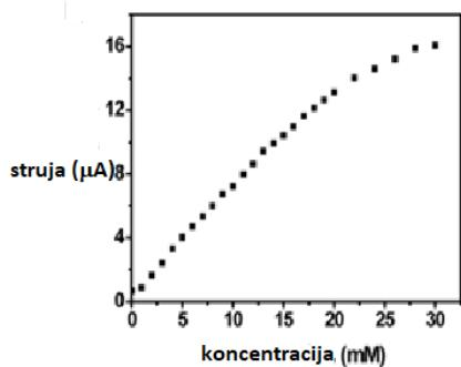
Slika 2. Grafički prikaz ovisnosti struje o koncentraciji laktata. Adaptirano iz reference [8].
