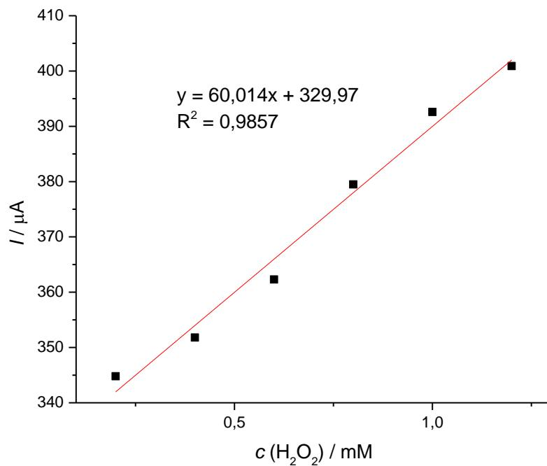
Slika 27. Grafički prikaz ovisnosti struje oksidacije o koncentraciji  $\text{H}_2\text{O}_2$  u fosfatnom puferu ( $\text{pH} = 6,1$ ).
