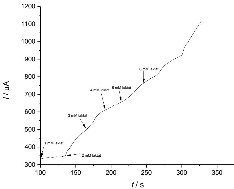
Slika 28. Kronoamperometrijski odziv laktata u fosfatnom puferu ( $\text{pH} = 6,1$ ) na plošnoj elektrodi uz miješanje pri potencijalu od - 0,1 V.
