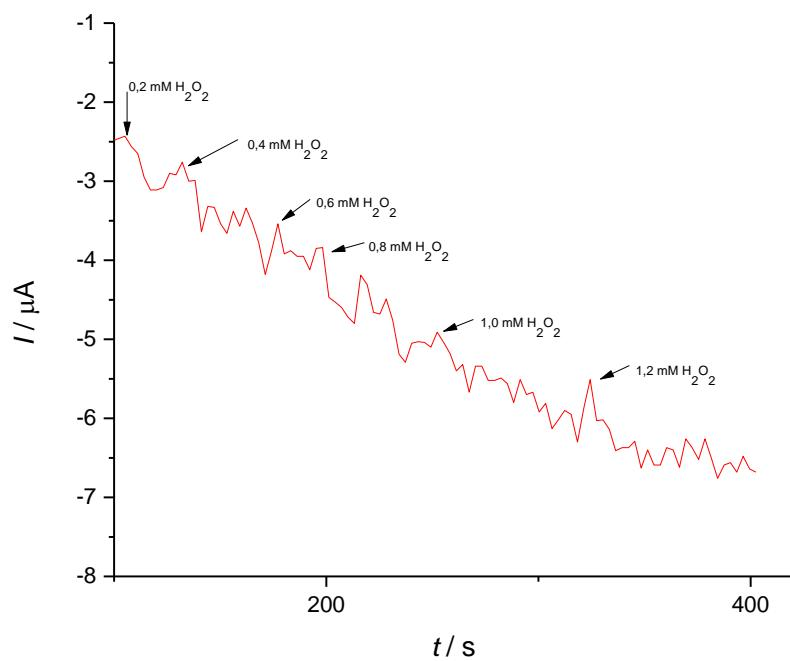
Slika 18. Kronoamperometrijski prikaz dodatka 0,1 M otopine  $\text{H}_2\text{O}_2$  u fosfatni pufer ( $\text{pH} = 5,5$ ) bez miješanja pri potencijalu od  $-0,1 \text{ V}$ .
