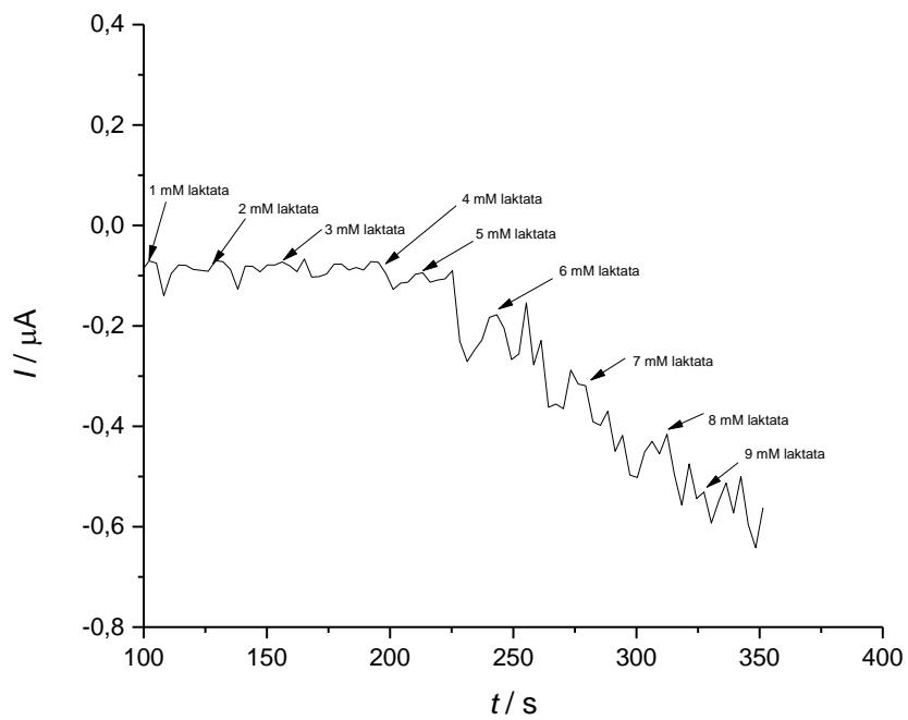
Slika 22. Kronoamperometrijski odziv laktata u fosfatnom puferu ( $\text{pH} = 6,5$ ) uz miješanje pri potencijalu od  $-0,1 \text{ V}$ .
