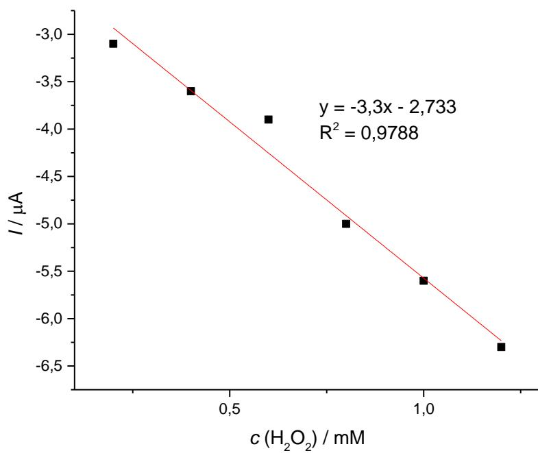
Slika 19. Grafički prikaz ovisnosti struje redukcije o koncentraciji vodikovog peroksida u fosfatnom puferu ( $\text{pH} = 5,5$ ).
