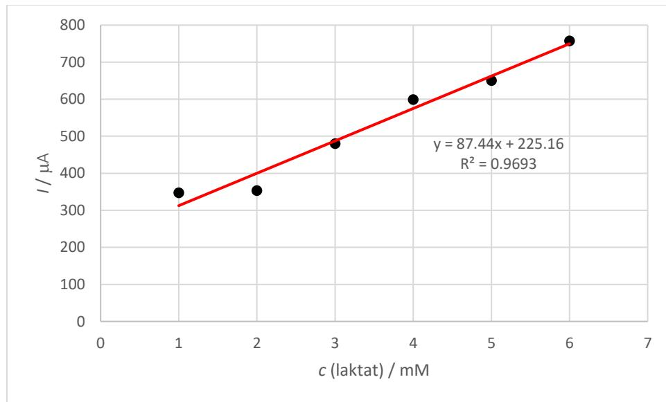
Slika 29. Grafički prikaz ovisnosti struje oksidacije o koncentraciji laktata u fosfatnom puferu ( $\text{pH} = 6,1$ ).
