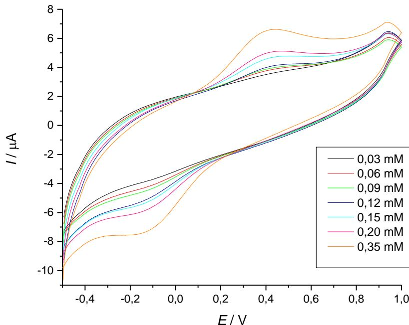
Slika 8. Odziv elektrode od staklastog ugljika u puferu dodatkom K<sub>3</sub>Fe(CN)<sub>6</sub> bez miješanja.
