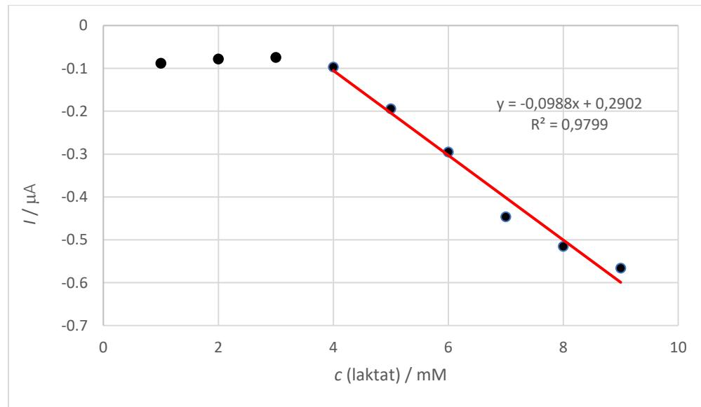
Slika 23. Grafički prikaz ovisnosti struje redukcije o koncentraciji laktata u fosfatnom puferu ( $\text{pH} = 6,5$ ).
