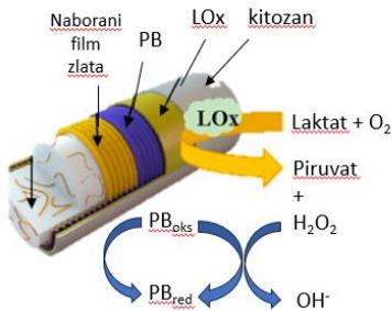
Slika 3. Dizajn radne elektrode elektrokemijskog senzora. Adaptirano iz reference [9].
