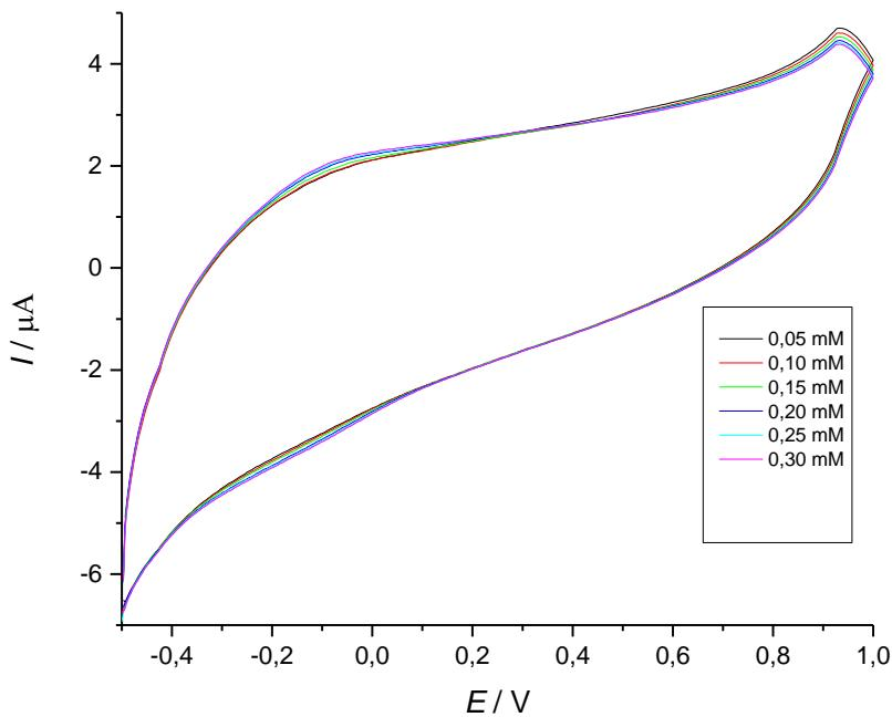
Slika 11. Odziv elektrode od staklastog ugljika u puferu ( $\text{pH} = 7,387$ ) dodatkom mlijecne kiseline bez miješanja.
