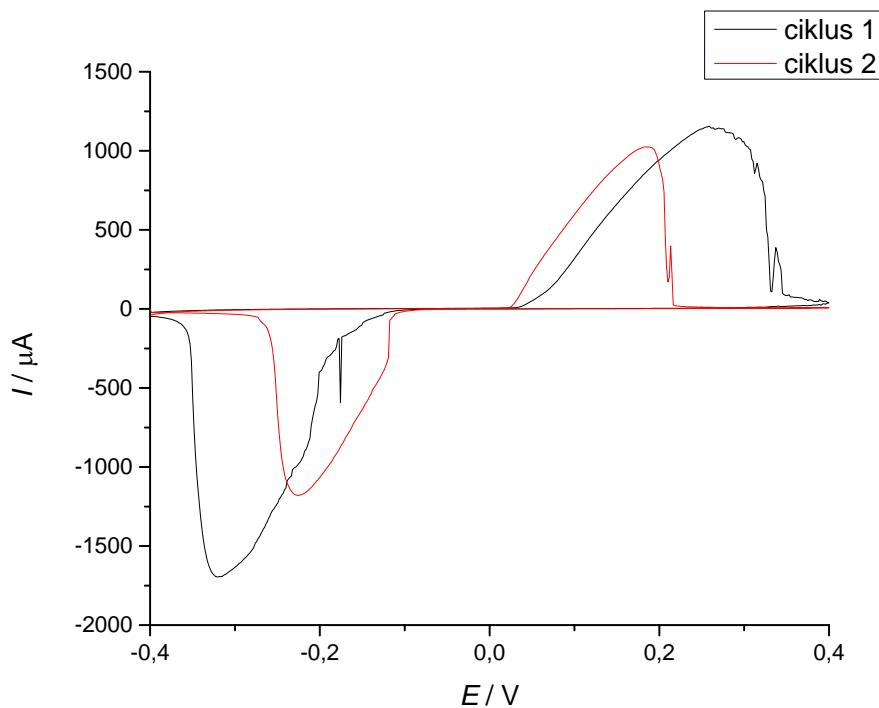
Slika 24. Odziv plošne elektrode u fosfatnom puferu ( $\text{pH} = 7,387$ ).
