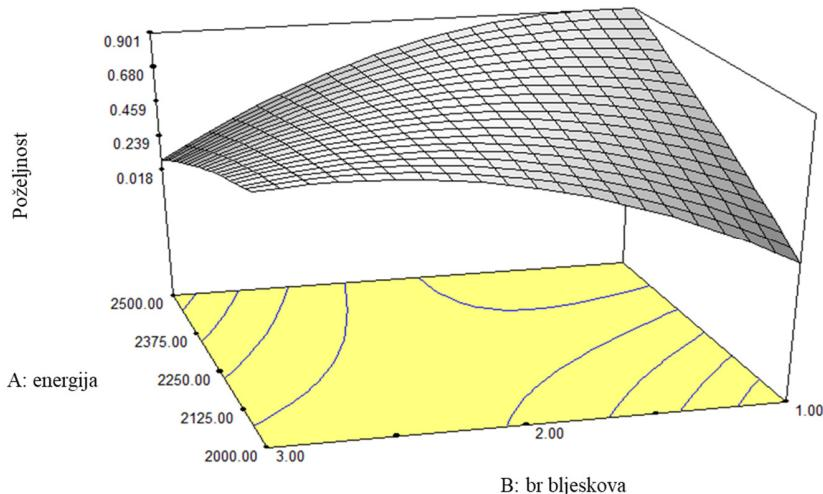
Slika 30. 3D grafički prikaz utjecaja energije i broja bljeskova na poklapanje modela sa izmjerjenim podacima.
