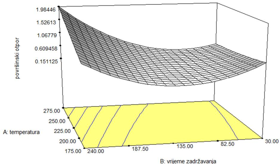
Slika 21. 3D grafički prikaz utjecaja vremena zadržavanja i temperature na površinski otpor.
