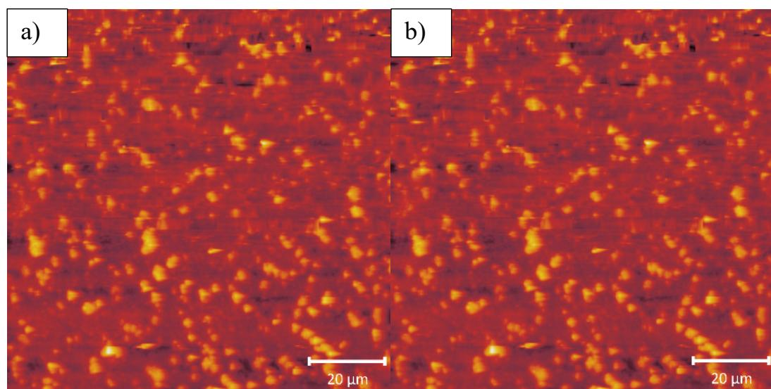
Slika 40. Prikaz površine *inkjet* tiskane nanosrebrne tinte na staklu a) prije fotermalne obrade; b) nakon obrade pri optimalnim uvjetima  $E = 2500 \text{ J}$ ,  $U = 3000 \text{ V}$  te jednom bljesku.
