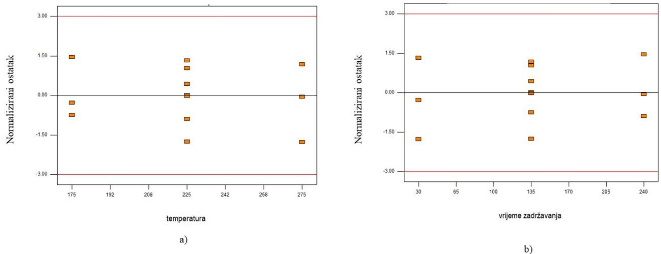
Slika 18. Grafički prikaz ovisnosti normaliziranih ostataka a) temperaturi b) vremenu zadržavanja u peći.
