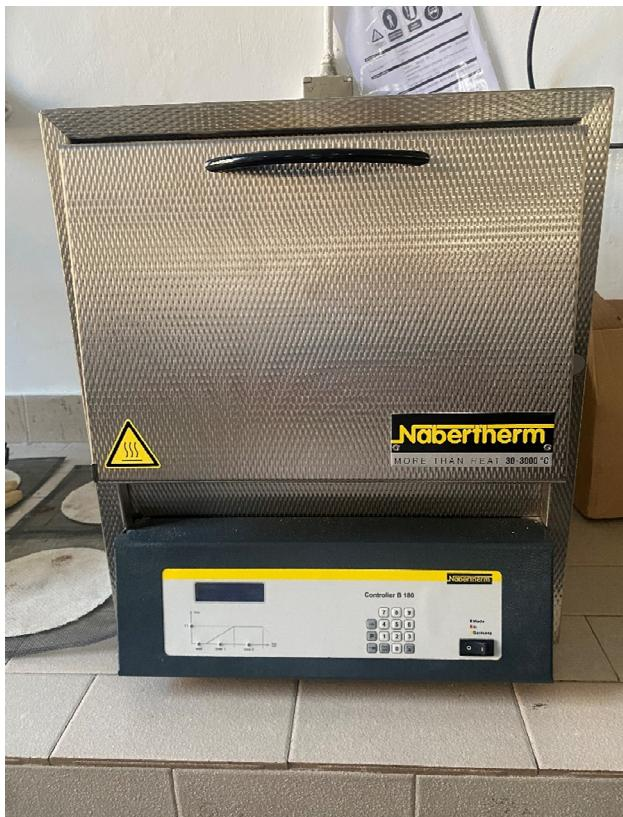
Slika 10. Peć u kojoj se provodi toplinska obrada.
