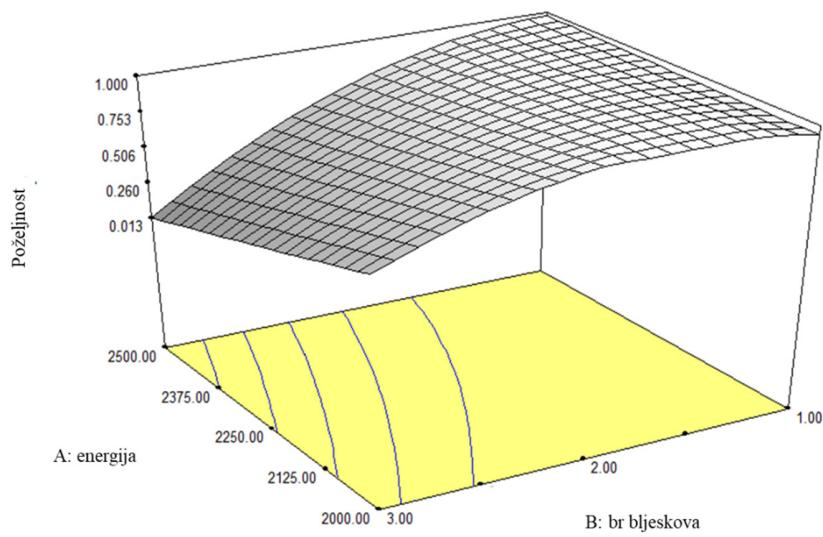
Slika 38. 3D grafički prikaz utjecaja energije i broja bljeskova na poklapanje modela s eksperimentalnim rezultatima.
