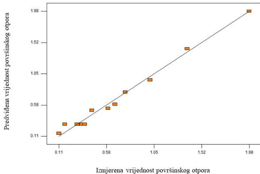
Slika 20. Grafički prikaz ovisnosti predvidene i izmjerene vrijednosti površinskog otpora.
