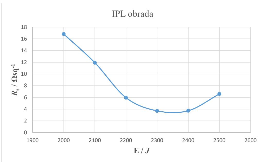
Slika 14. Grafički prikaz ovisnosti površinskog otpora o energiji pri konstantnom naponu od 3000 V pri fotermalnoj obradi za preliminarna ispitivanja.
