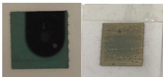
Slika 31. Prikaz usporedbe *inkjet* ispisanе tinte s amfifilnim nanočesticama srebra na staklu prije (lijevo) i nakon IPL obrade (desno) podignite od podloge za 2 mm pri 3000 V, 2500 J i 2 bljeska.
