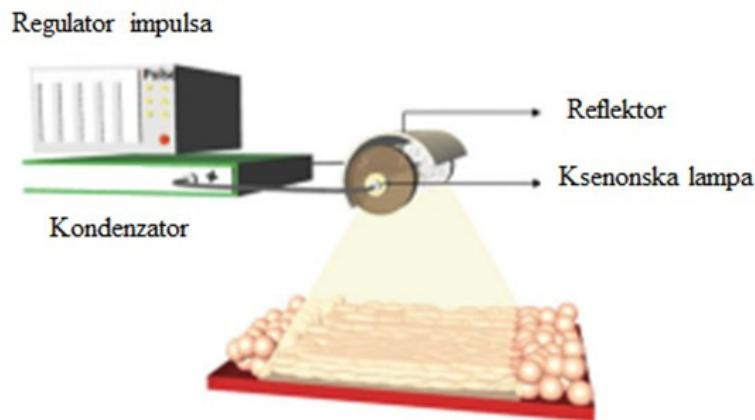
Slika 3. Uređaj koji emitira intenzivno pulsirajuće svjetlo, sastoji se od ksenonske lampe, reflektora, sustava za napajanje, kondenzatora i regulatora impulsa [10].
