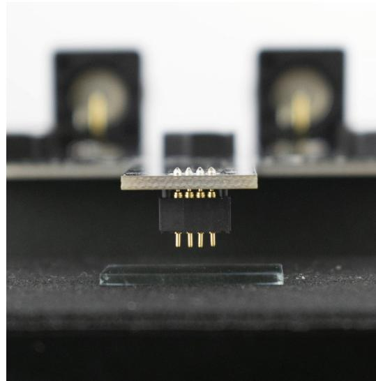
Slika 8. Sonda za mjerjenje površinskog otpora u 4 točke (uvećan prikaz).
