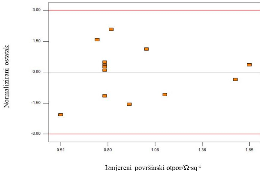
Slika 25. Grafički prikaz ovisnosti izmjerjenog površinskog otpora o normaliziranom ostatku.
