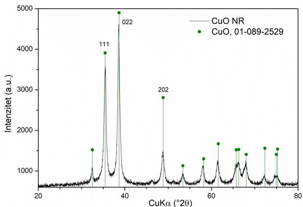
Slika 9. Difraktogram pripravljenog uzorka
