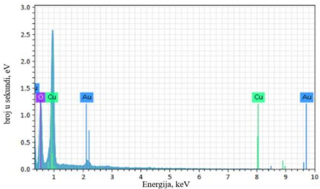
Slika 14. Grafički prikaz EDS analize pripravljenog uzorka
