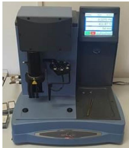
**Slika 15.** Termogravimetar, Q500 TA Instruments
