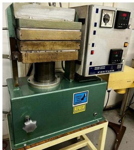
**Slika 13.** Hidraulička preša Fontune, Holland (SRB 140, EC 320x320NB)
