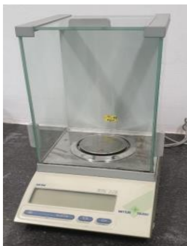
Slika 13. Analitička vaga Mettler Toledo, AB 104, Švicarska
