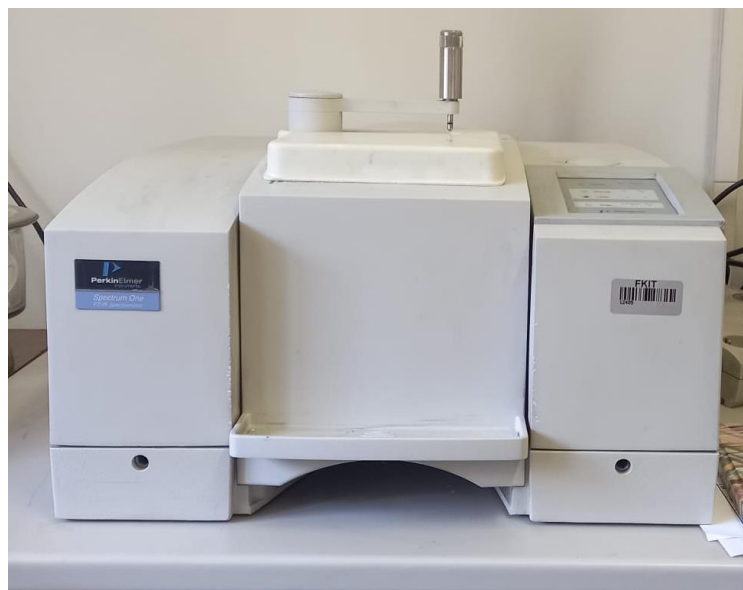
Slika 16. FTIR spektrofotometar PerkinElmer, Spectrum One
