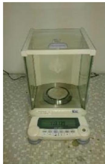
Slika 3.1. Analitička vaga Shimadzu
