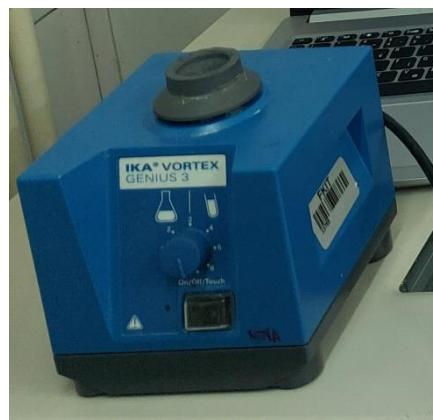
Slika 3.2. Homogenizator Vortex 3- IKA
