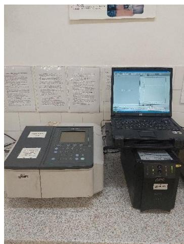
Slika 3.3. Spektrofotometar *Shimadzu UV-1800*
