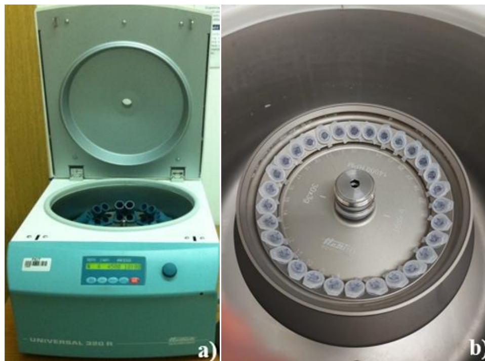
Slika 3.4. a) Centrifuga Hettich Universal 320R i b) rotor
