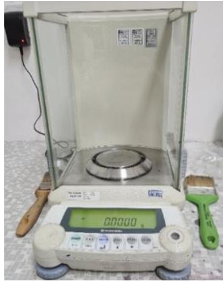
Slika 3.2. Analitička vaga Shimadzu AUW 120
