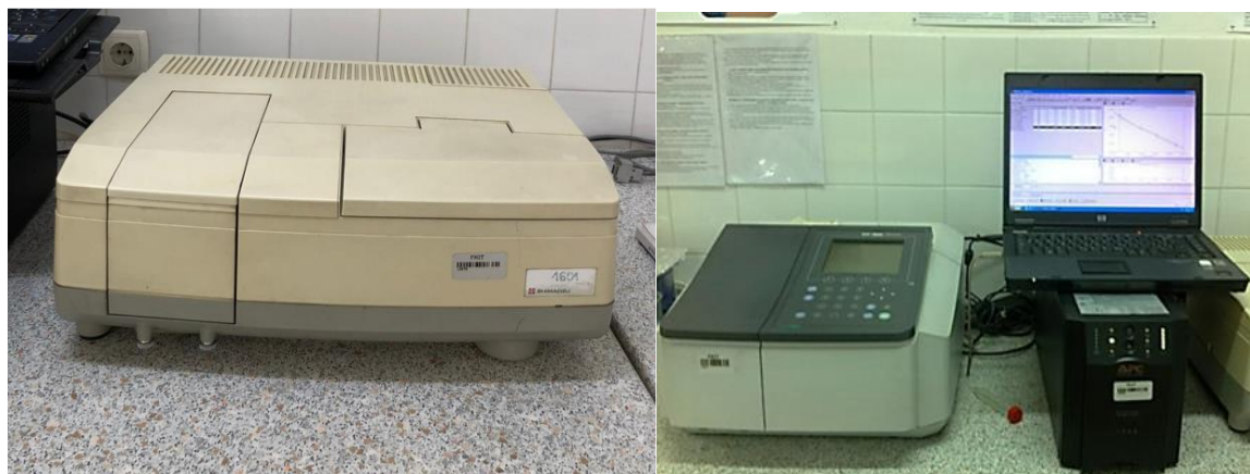
Slika 3.5. Spektrofotometar Shimadzu a) UV-1601 i b) UV-1800
