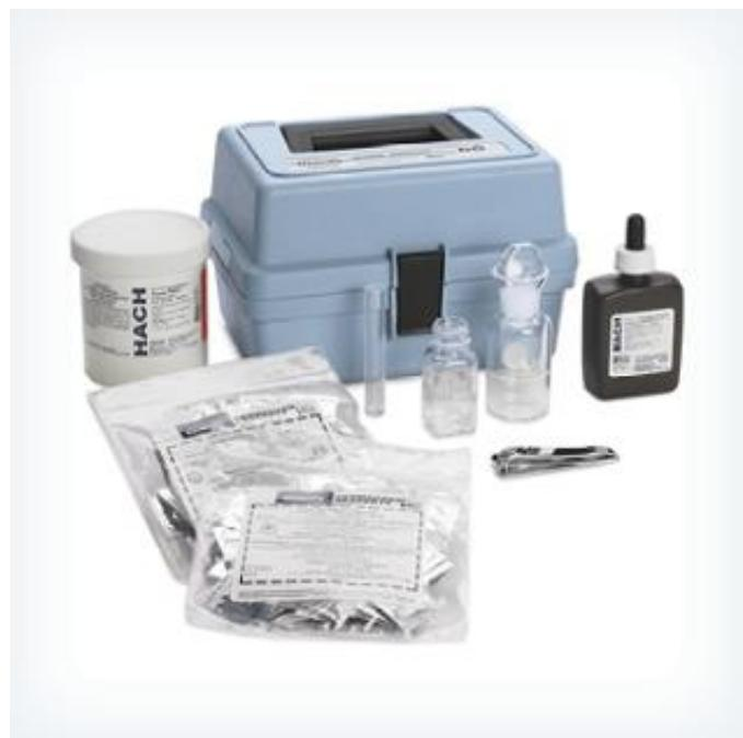
**Slika 13.** Komplet za izvođenje jodometrijske metode [11]
