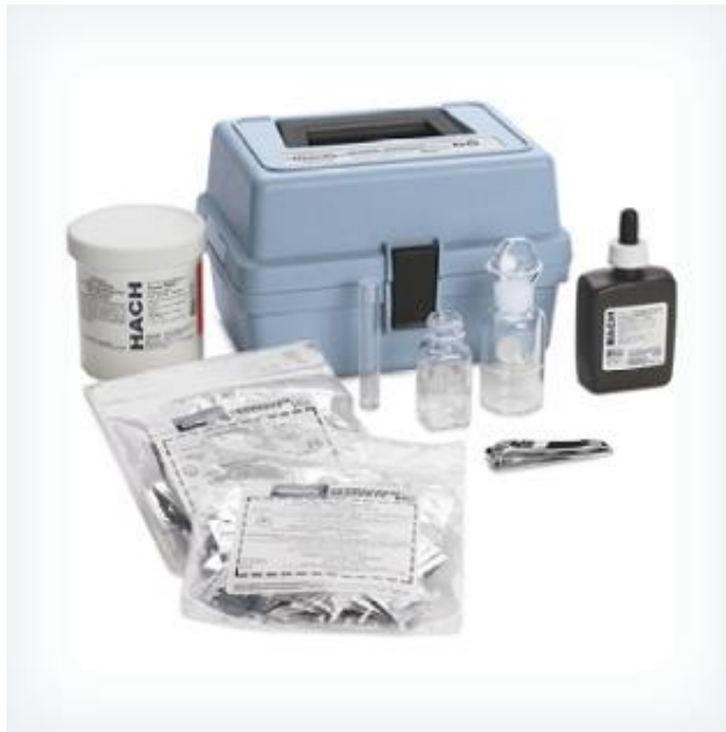
Slika 13. Komplet za izvođenje jodometrijske metode [11]
