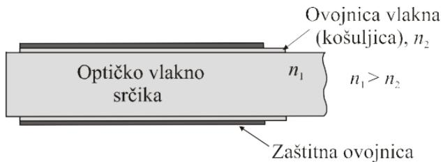
**Slika 23.** Presjek građe cilindričnoga svjetlovoda odnosno optičkoga kabela [29]
