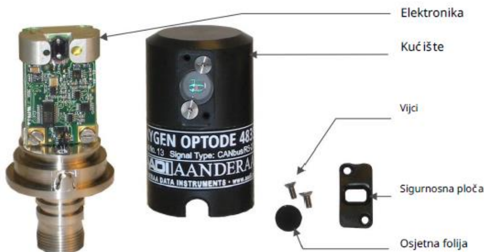
Slika 41. Ilustracija unutrašnjosti Aanderaa Oxygen Optode 4835 [38]
