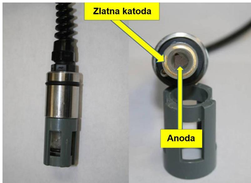
**Slika 15.** Membranska elektroda koja se koristi za mjerjenje otopljenog kisika [6]
