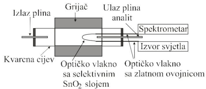
**Slika 20.** Primjer načela rada senzora zasnovanog na apsorpciji unutar utnjujućeg polja (protočni senzor za vodik u inertnom plinu N<sub>2</sub>) [29]
