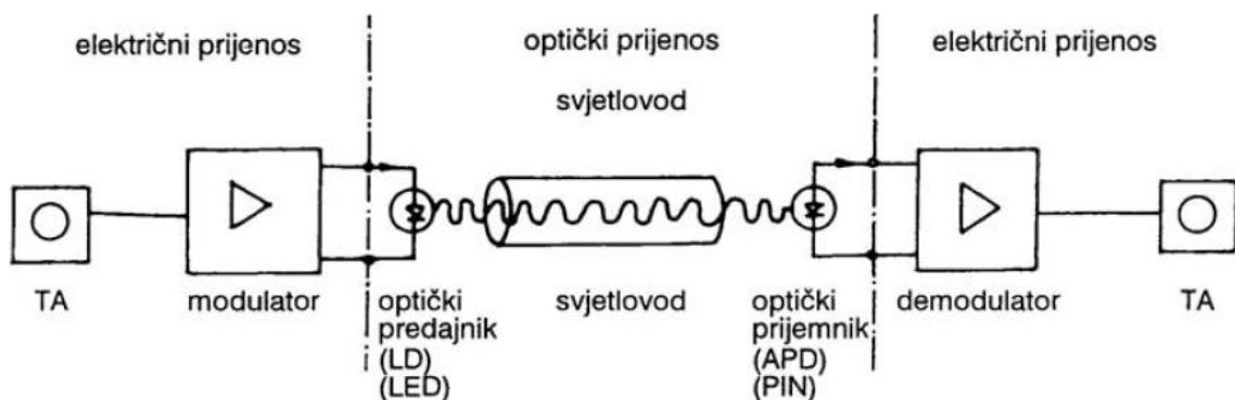
**Slika 29.** Princip prijenosa signala pomoću svjetlosti [29]
