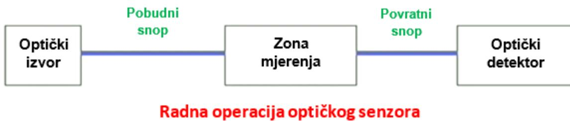
**Slika 28.** Općeniti prikaz radne operacije optičkog senzora [29]
