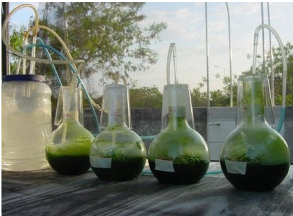
Slika 6. Primjer solarnog fotobioreaktora za proizvodnju biovodika iz algalne biomase [36]
