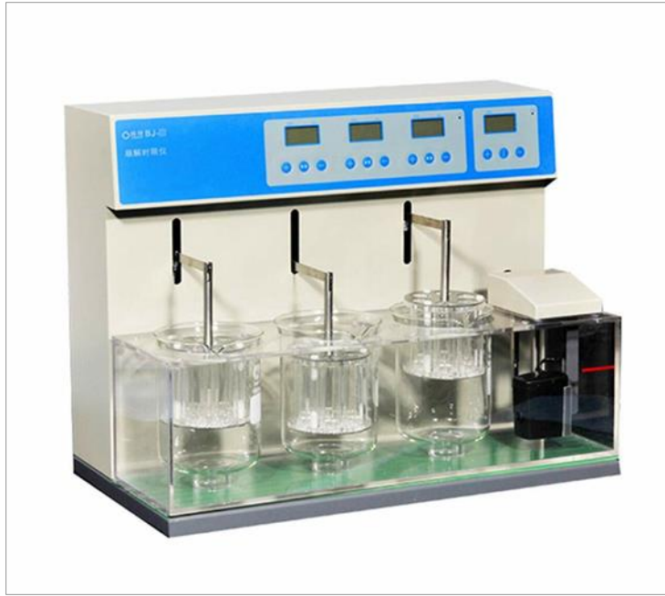
Slika 11. Fotografija uređaja za ispitivanje raspadljivosti tableta BJ 2 (Zhengzhou Nanbei Instrument, Henan, NR Kina)
