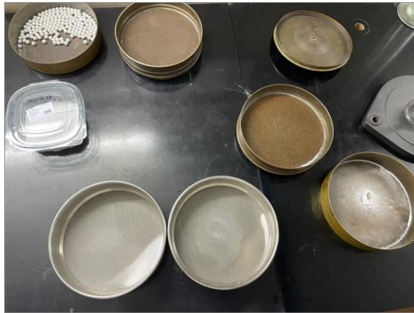
Slika 14. Fotografija sita s prosijanim Pardeckom
