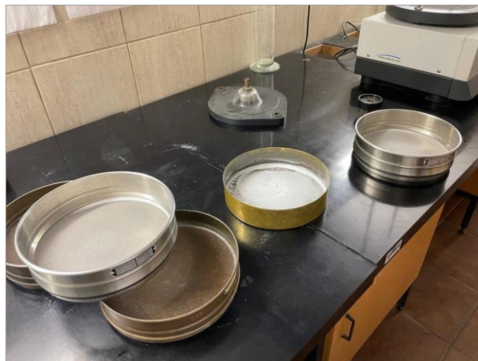
Slika 16. Fotografija sita s prosijanim D(-) manitolom
