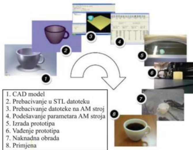
Slika 2.6. Prikaz pojedinih stupnjeva procesa aditivne proizvodnje[22]
