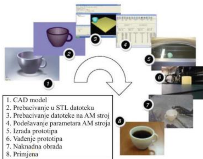
Slika 2.6. Prikaz pojedinih stupnjeva procesa aditivne proizvodnje[22]
