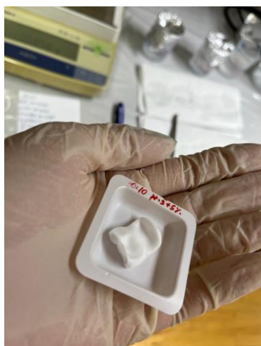
Slika 21. Izgled hidrogela PLA + p.š. + 5 mas.% l.k./NMP (omjer 90:10) nakon a) 24 h i b) 336 h bubrenja
