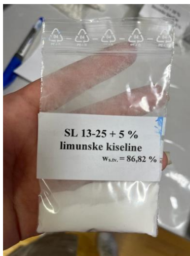
Slika 11. Uzorak prirodnog škroba s 5 mas. % limunske kiseline
