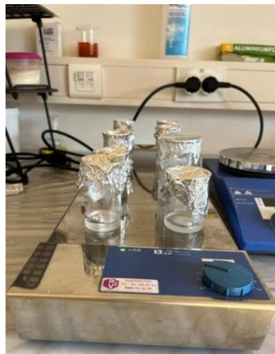
Slika 12. Pripremljene polimerne otopine na magnetskoj mješalici
